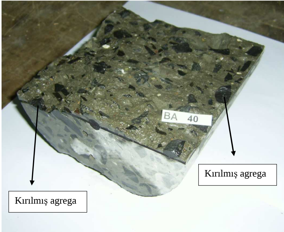
Şekil B.10 : Yarma deneyinde kırılma yüzeyi.
