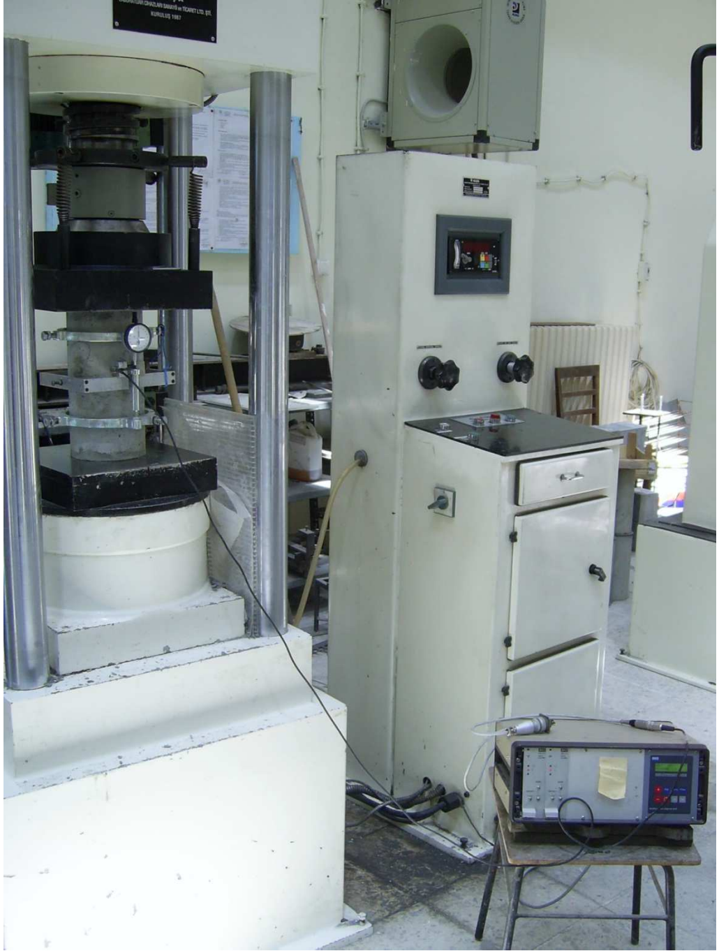
Şekil B.8 : Yatay ve Düşey Deplasman Ölçüm Düzeneği.
