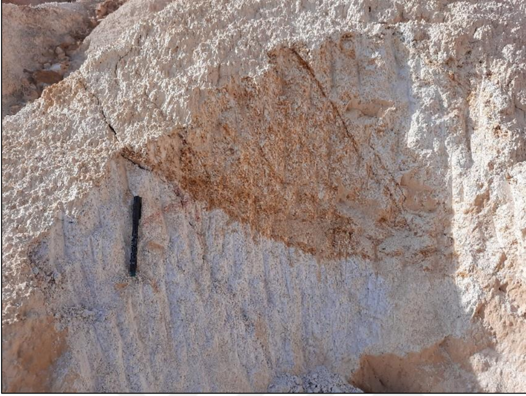
Şekil 2.20 : Kaolen oluşumunun demir oksit/hidroksit getirimli geçişleri.
