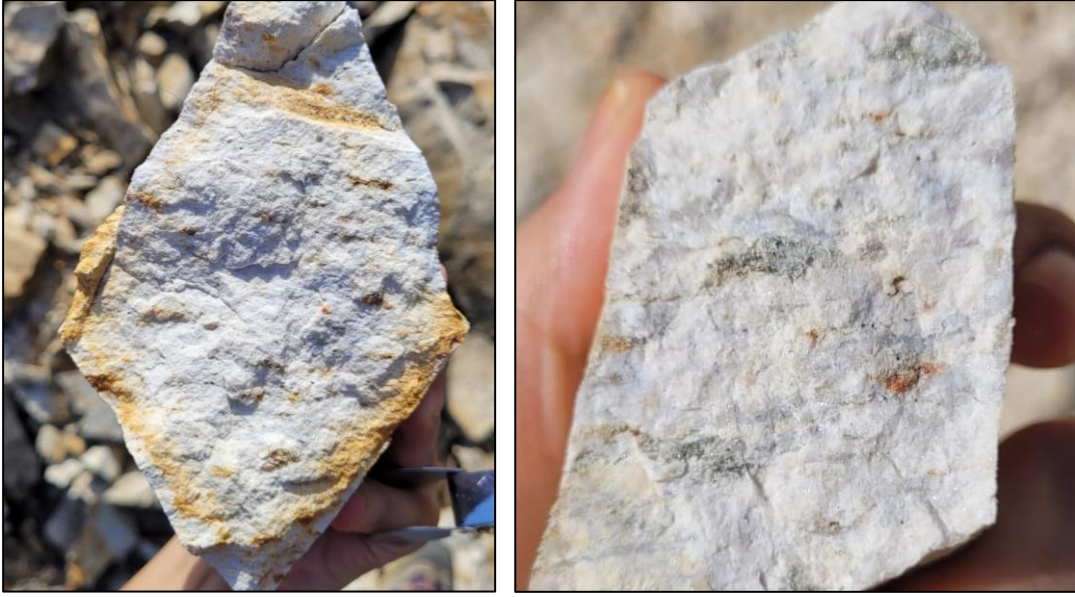
Şekil 2.8 : Metagranitin makro görünümü. Açık renkli minerallerin baskın olması sebebiyle lökokratik olarak sınıflandırılmıştır. Tane boyutu ince-ortadır.
