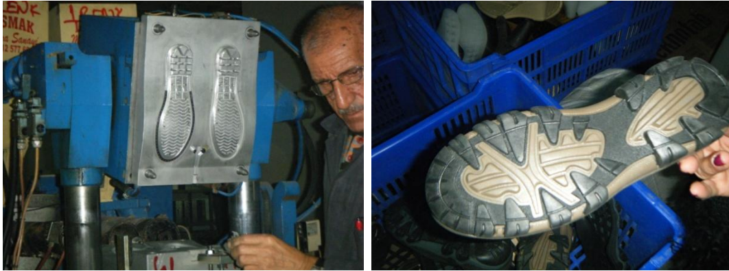
Şekil 3.16 : a-b.Tabanın kalıplama tekniği ile basılması (Pames Grup).
