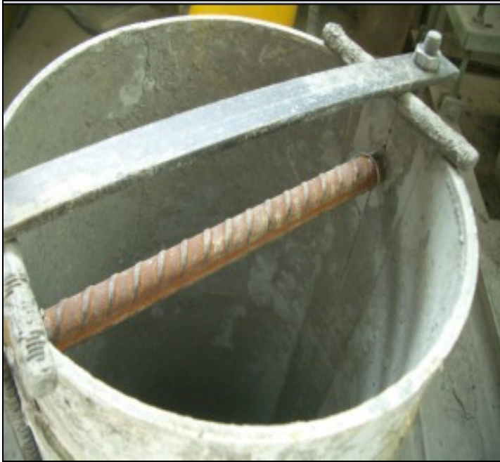
Şekil 3.2: Oturma çatlağının gözlemlendiği numune kalıbının fotoğrafları
