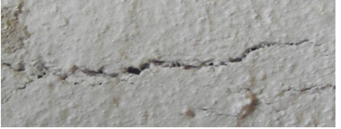
Şekil 4.30: C21 lifli numunesinin yüzeyindeki çatlağın yakın fotoğrafı
