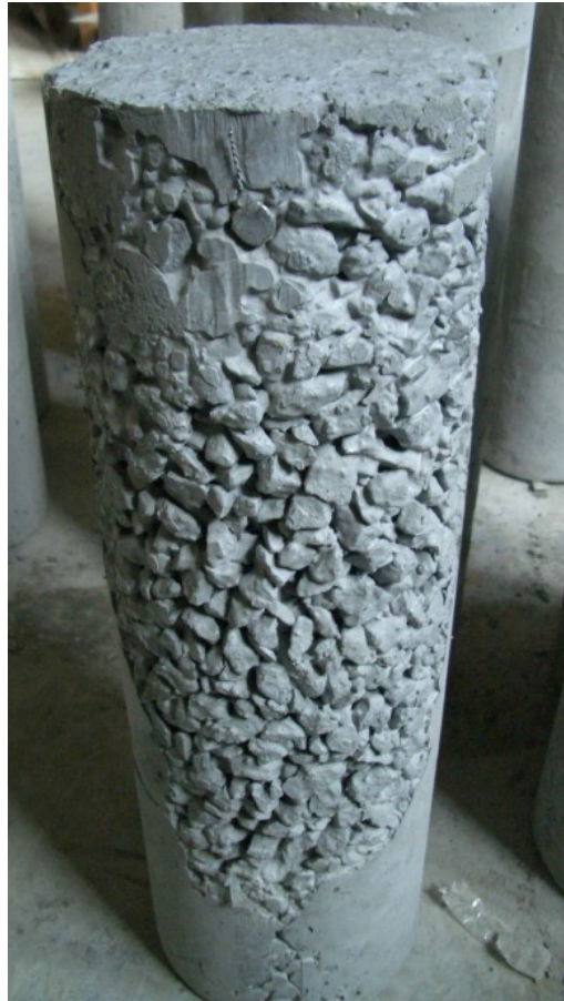
Şekil 4.4: A3 numunesinde oluşan iskelet formu
