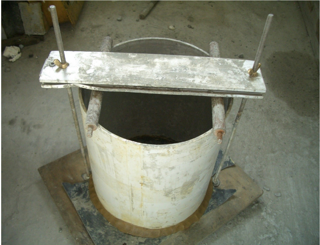
Şekil 3.5: Terleme miktarının gözleendiği numunenin kalıbı
