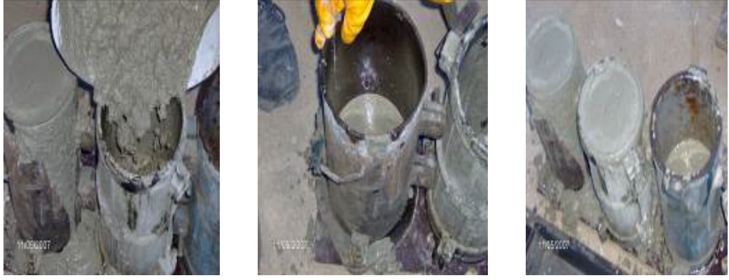
Şekil 2.1: Silindir Numunelerinin Hazırlanışı
