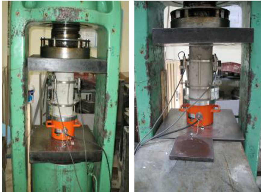
Şekil 2.2: 28 Günlük Beton Basınç Dayanımı ve Elastisite Modülü Deney Düzeneği
