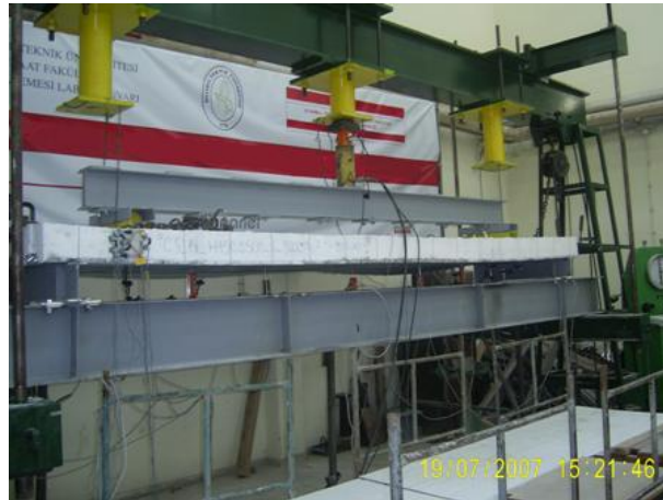
Şekil 2.106 : CS_1S_H150_S08_6_3200 Numunesinin Deney Öncesi Görünüşü
