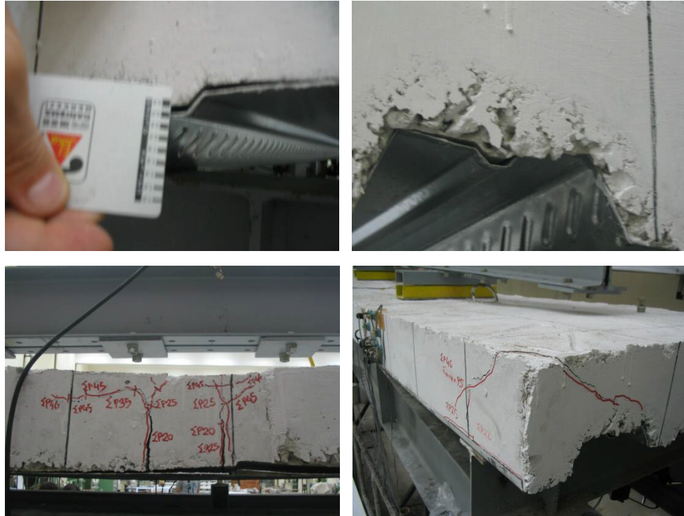
Şekil 2.33 : CS_1S_H150_S08_1_1400 Numunesinde Gözlenen Hasarlar
