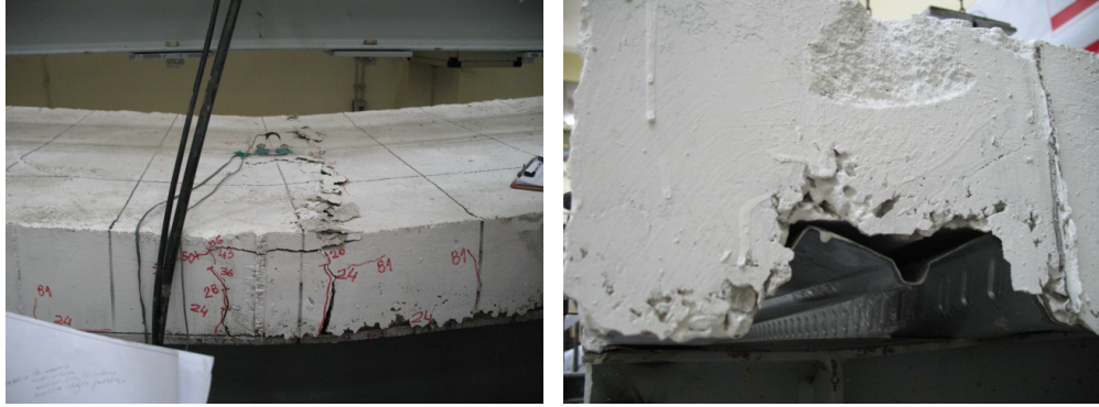
Şekil 2.81 : CS_1S_H150_S08_4_2400 Numunesinin Deney Sonrası Görünümü
