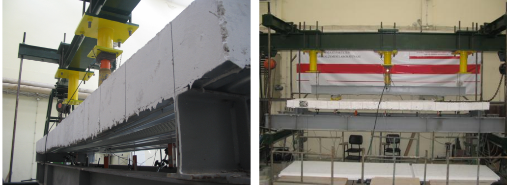
Şekil 2.61 : CS_1S_H150_S08_3_2400 Numunesinin Deney Öncesi Görünüşü
