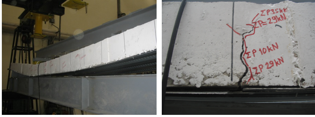
Şekil 2.66 : CS_1S_H150_S08_3_2400 Numunesinin Deney Sonrası Resimleri
