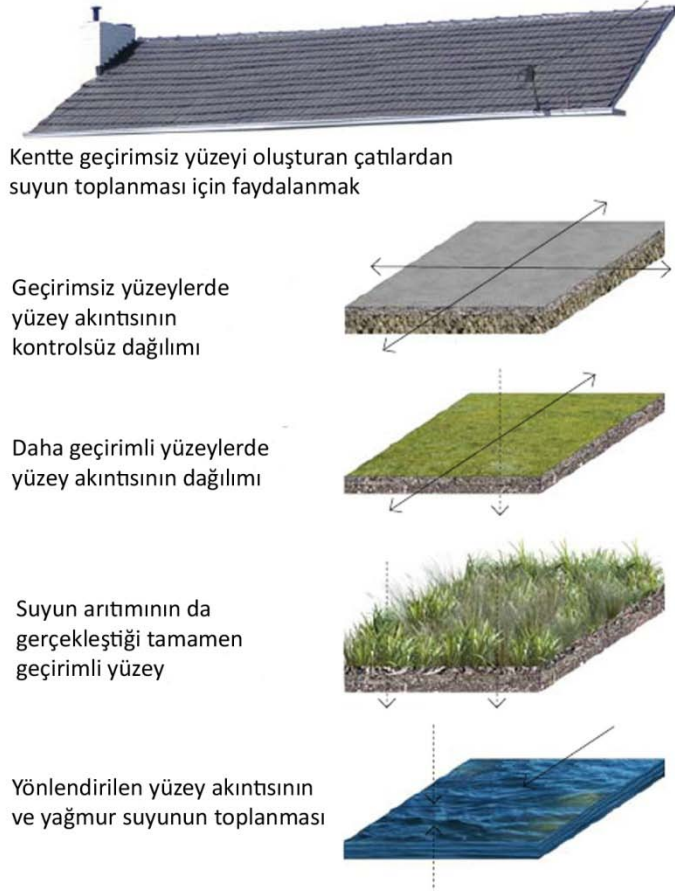
Şekil 3.19 : Farklı yüzeylerdeki suyun davranışı ile ilgili görsel anlatım. Blood'un (2006) çalışmasından alınmış, Esra Sert (2013) tarafından yorumlanmış, Türkçe'ye çevirilmiştir.
