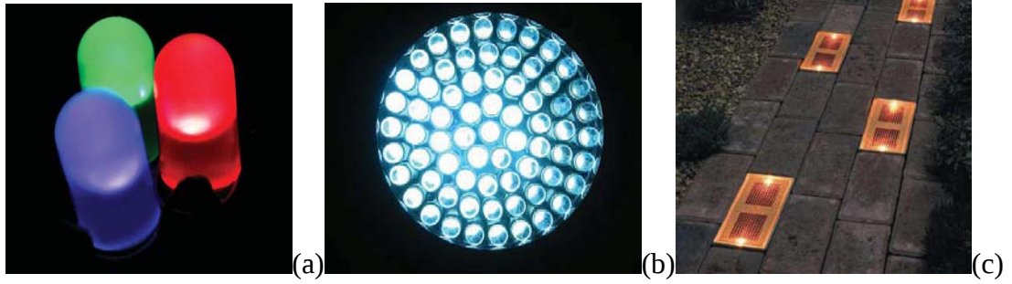
Şekil 4.27 : (a)Işık yayan diyot (CLTC, 2008) (b)led döşemesi (CLTC, 2008) (c) birden fazla ışık yayan diyot bir araya gelerek LED aydınlatmasını oluşturur (CLTC, 2008).
