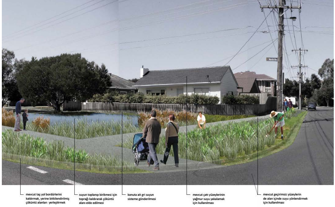
Şekil 3.22 : Melbourne’da Sokağın suya duyarlı tasarlanmasını anlatmak amaçlı foto montaj çalışması, Blood, (2006)’ dan alınmış, Esra Sert (2013) tarafından Türkçe’ye çevirilmiştir.
