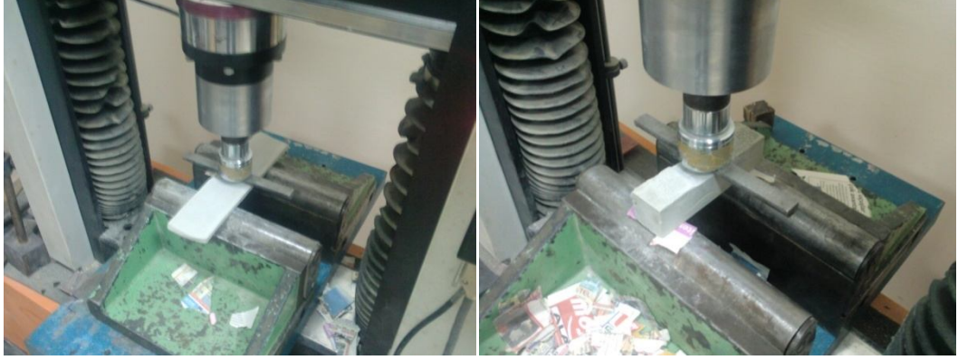
a) Levha numunelerde eğilme deneyi b) Prizma numunelerde eğilme deneyi
