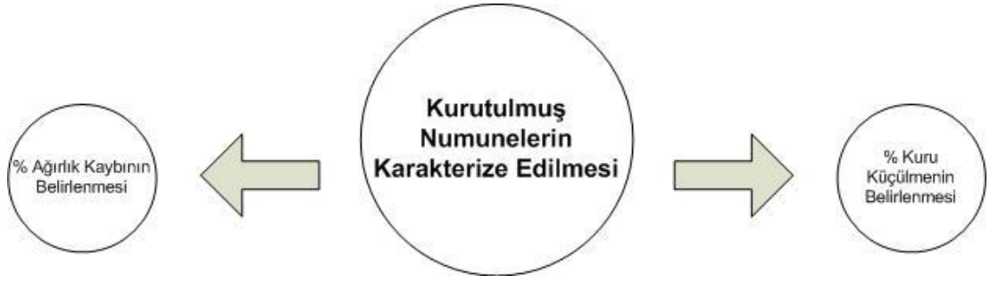
Şekil 6.13: Kurutma Sonrası Numunelerin Karakterizasyonun Şematik Gösterimi
