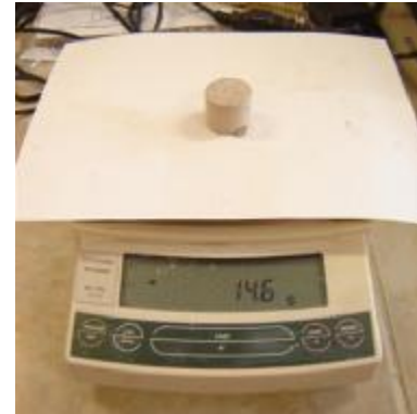
Şekil 7.22 : Ağ % 2 Seramik Fiber Katkılı Toza Ait Görünür Yoğunluk Deneyleri
