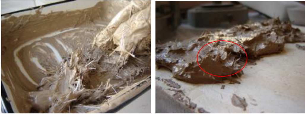
Şekil 7.3 : Cam Fiber Kullanılarak Şekillendirilme Süreci
