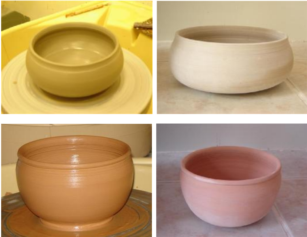
Şekil 7.73 : Ağ.% 2 Fiber Katkılı Bünyelerin Kuruma ve Bisküvi Pişirimi Sonrası Görüntüleri
