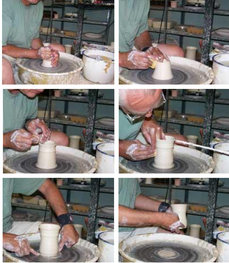
Şekil 4.4 : Çömlekçi Tornası ile Şekillendirme Örneği
