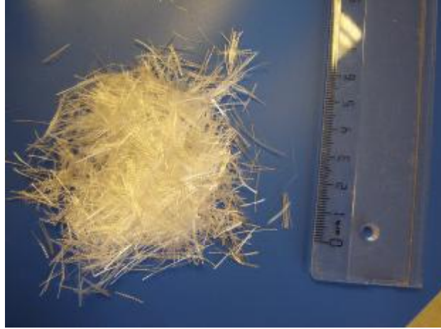
Şekil 7.2 : Cam Fiberlerin Görünümüne ait Makro Görüntü
