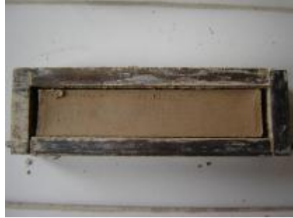
Şekil 7.27 : Kuruma Küçülmesi Gerçekleşmiş Fiber Katkısı Olmayan Bünyeye Ait Makro Görüntü
