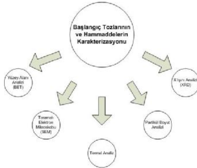
Şekil 6.1 : Başlangıç Tozlarının Karakterizasyonun Şematik Gösterimi
