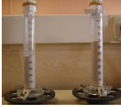
Şekil 7.21 : Fiber Olmayan (resimde solda) ve ağ % 6 Seramik Fiber Katkılı Toza (Resimde Sağda) Ait Çökme Yoğunluğu Ölçümleri
