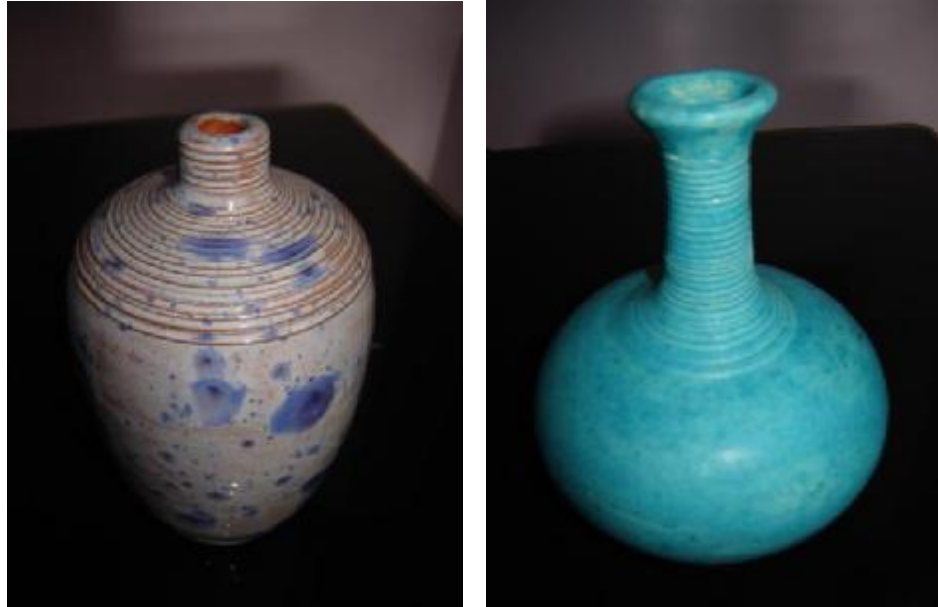
Şekil 7.74 : Ağ.% 2 Fiber Katkılı Bünyelerin Sırlama Sonrası Görüntüleri
