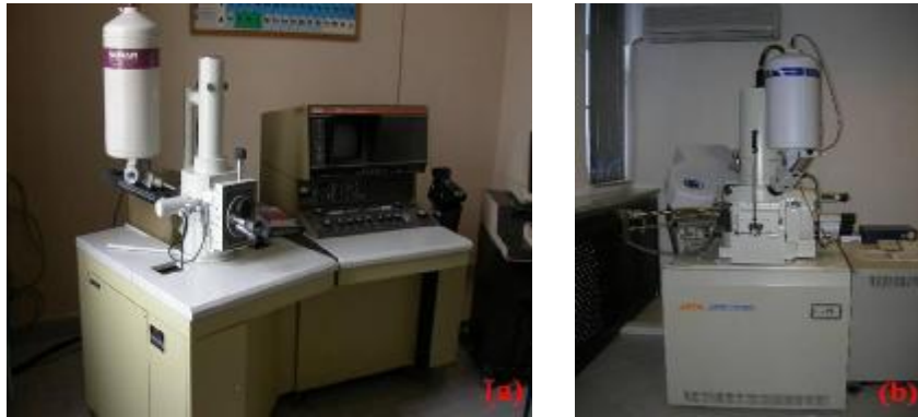
Şekil.6.17 : (a) Jeol™-JSM-T330 SEM Cihazının Görüntüsü, (b) Philips™ XL 30 FEG FE-SEM Cihazının Görüntüsü
