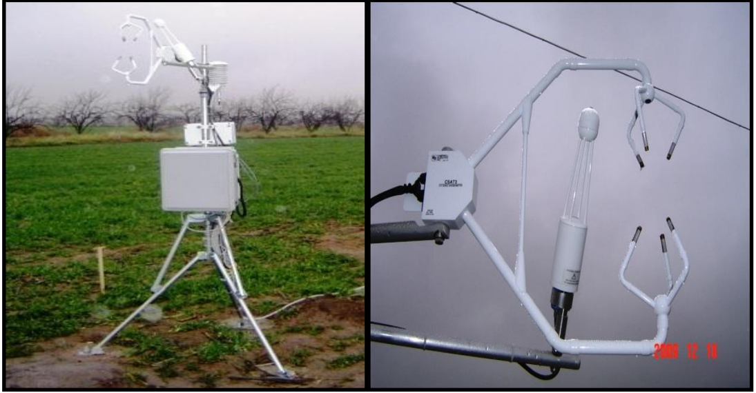
Şekil 2.3: Eddy Kovaryans Ölçüm Sisteminin Yakından Görüntüsü.
