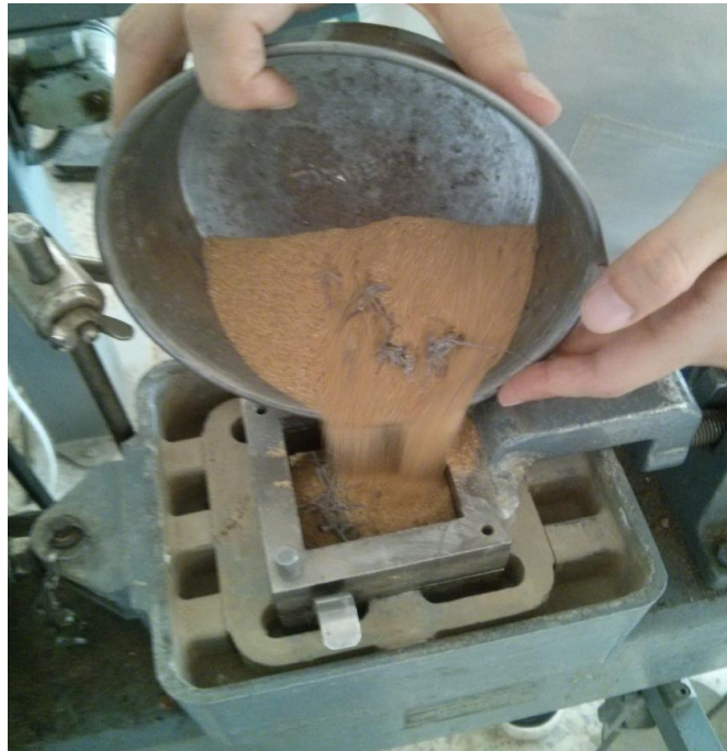
Şekil 4.11 : Direkt kesme kutusu deney hücreesine numune konulması.
