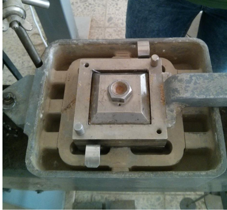
Şekil 4.15 : Üst numune tutucunun yerleştirilmesi.
