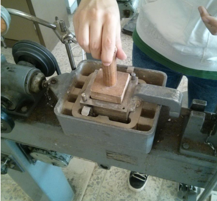
Şekil 4.12 : Deney numunesinin hücre içinde yerleştirilmesi.
