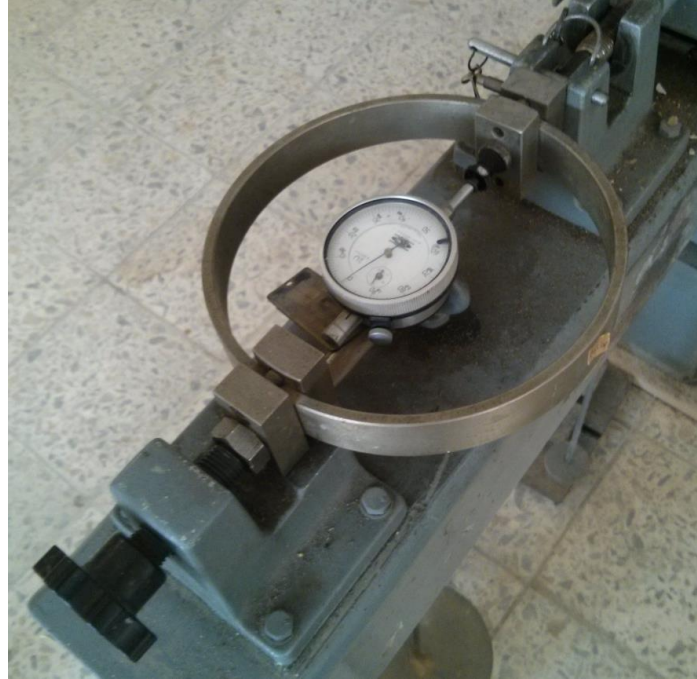
Şekil 4.19 : Yatay deformasyon okuma saatinin ayarlanması.
