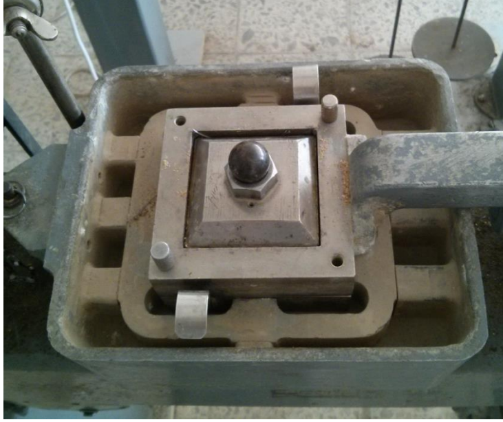
Şekil 4.16 : Numune üst tutucu konulduktan sonra bilye konulması.
