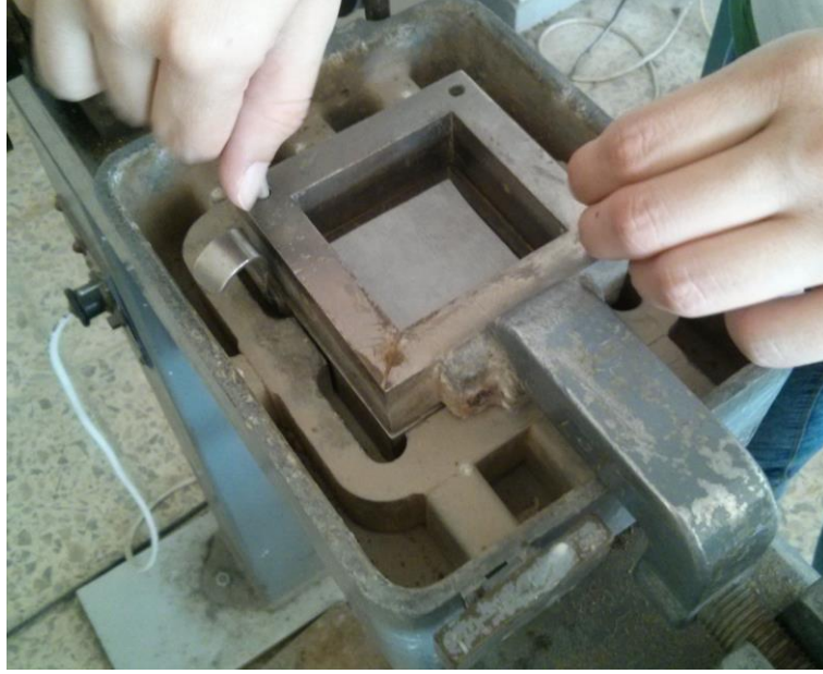
Şekil 4.10 : Direkt kesme kutusu hücreesine poroz kağıdı yerleşimi.
