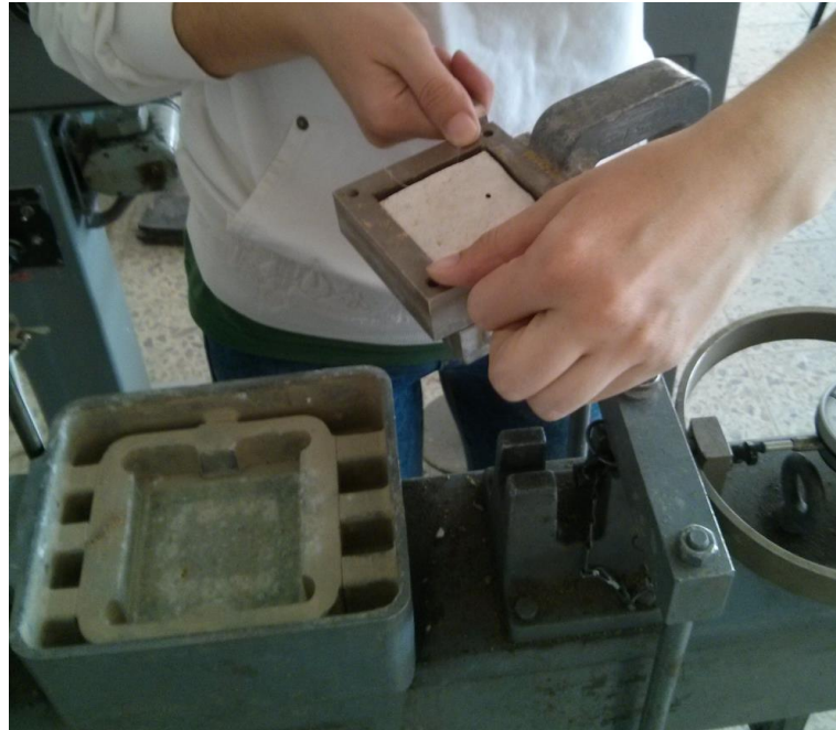
Şekil 4.22 : Kesme işlemi sonra yük kolunun kaldırılması.
