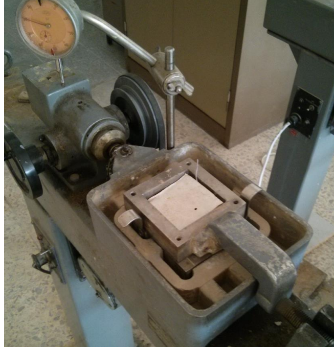
Şekil 4.22 : Kesme işlemi sonra yük kolunun kaldırılması.
