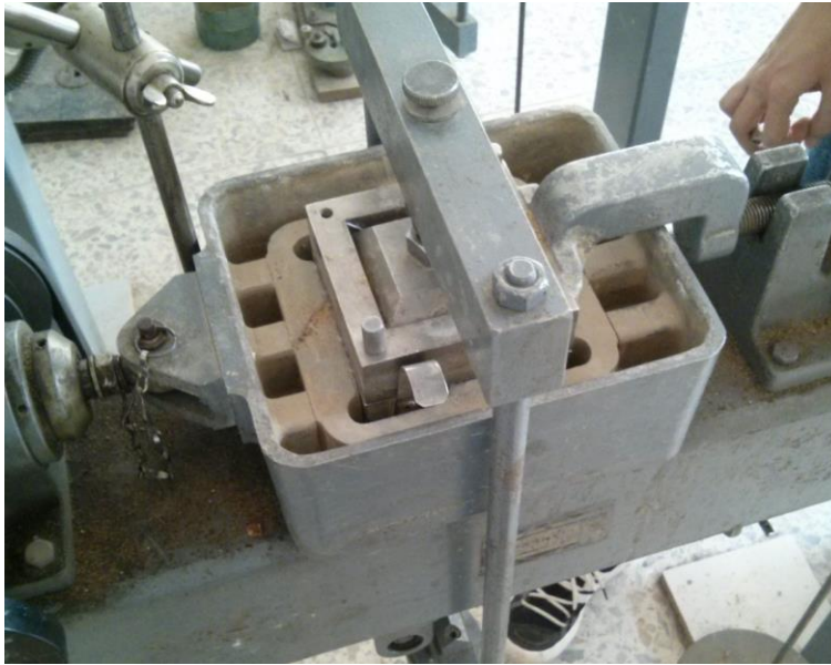
Şekil 4.17 : Kutu üzerine yükleme kolunun yerleştirilmesi.
