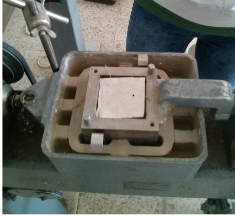
Şekil 4.14 : Numune kutuya konulduktan sonra üst poroz kağıdının konulması.
