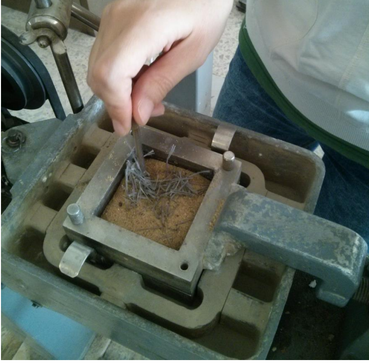
Şekil 4.12 : Deney numunesinin hücre içinde yerleştirilmesi.
