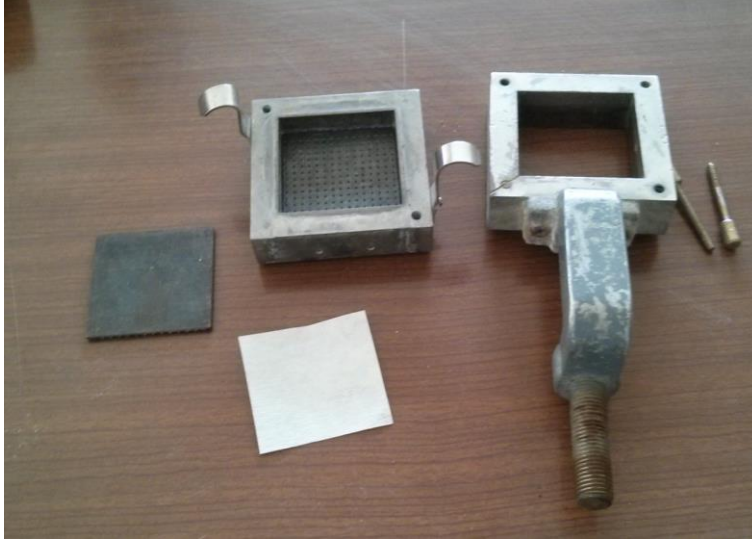
Şekil 4.8 : Direkt kesme kutusu alt ve üst parçaları.
