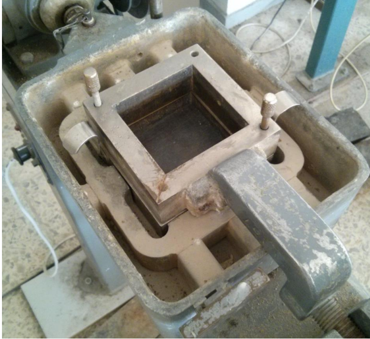
Şekil 4.9 : Direkt kesme kutusu numune koyma hücresi.
