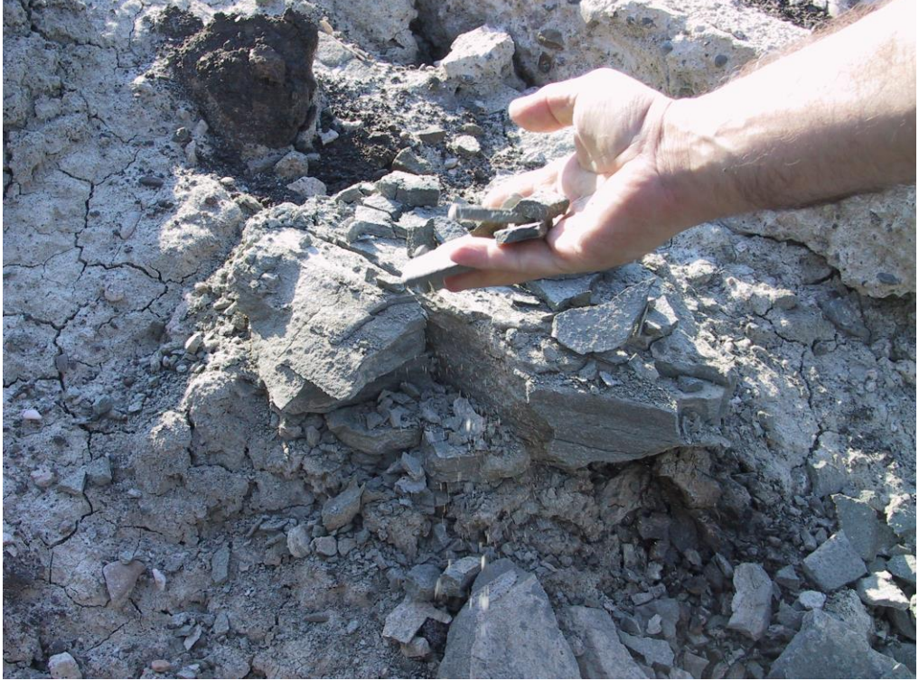
Şekil 3. 3: Hapan Tüneli Kazılarında Çıkan Bazaltik Tüf ve Aglomera Litolojileri
