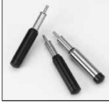
Şekil 3.29. Penetrometre deney aleti.
