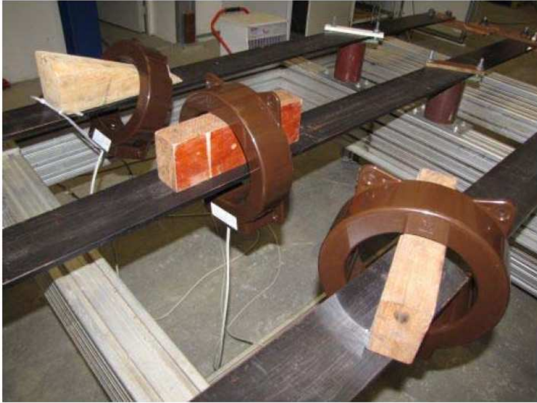
Şekil 5.5: 2. Deney – Akım Transformatörlerinin Açılı Bağlanması
