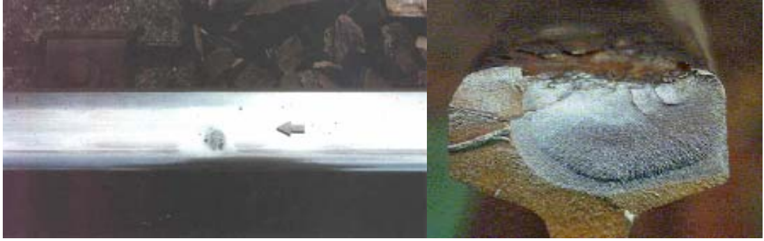
Şekil 4.9: Ray Mantarındaki Kabuklanmalar
