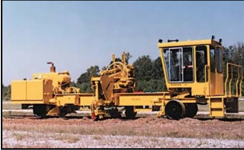
Şekil 4.23: Travers Değiştirme Makinesi İle Travers Değiştirme
