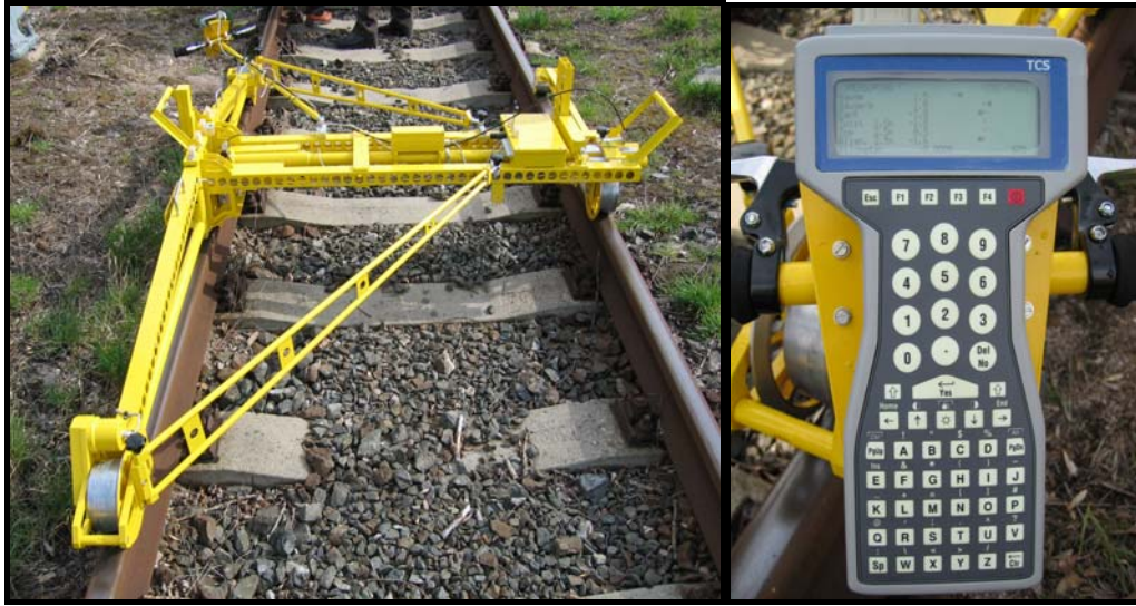
Şekil 3.3: Hat Geometrisi Ölçüm Cihazı ve El Bilgisayarı
