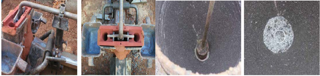
Şekil 4.18: Kalıpların Hazırlanması ve Potanın Neminin Alınması
