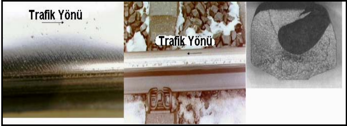
Şekil 4.7: Ray Yuvarlanma Temas Yüzeyinin Yorulması
