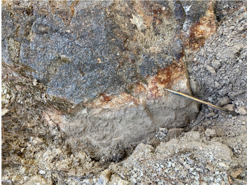
Şekil 6.11 : Kuvars damarı ve etrafında gelişen kil+serizit+silis alterasyonu.
