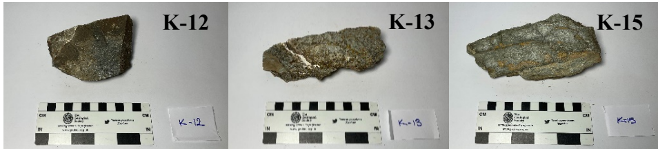
Şekil 5.7 : Çetmi Melanjına ait kayaçlardan alınan numuneler: K-12 (gabbro-foid gabbro), K-13 (monzodiyorite-gabroik diyorit), K-15 (fillat).
