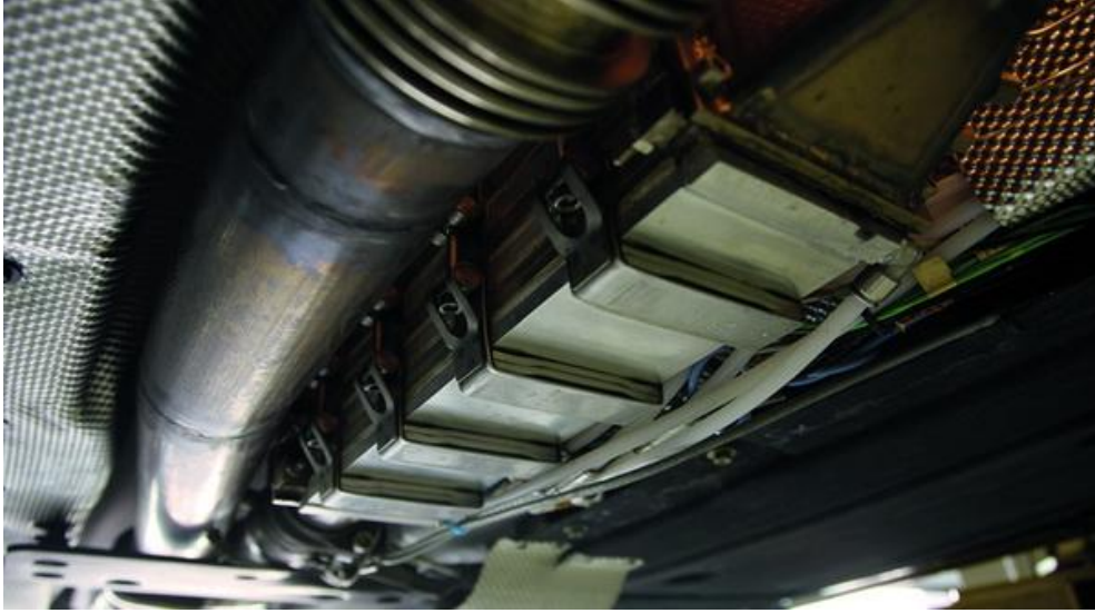
Şekil 2.8 : BMW marka otomobilin atık ısı termoelektrik jeneratörü.
