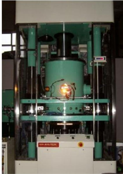
Şekil 4.2 : Deneysel çalışmalarda da kullanılan SPS Syntex marka ve SPS-7.40MK-VII model SPS cihazı.
