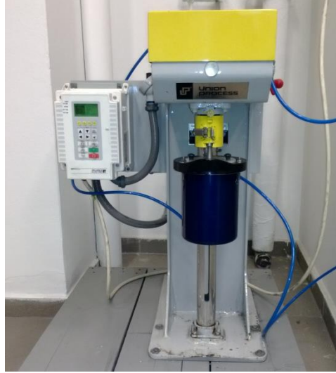
Şekil 6.8 : Mekanik aktivasyon çalışmalarında kullanılan Union Process marka atritör.
