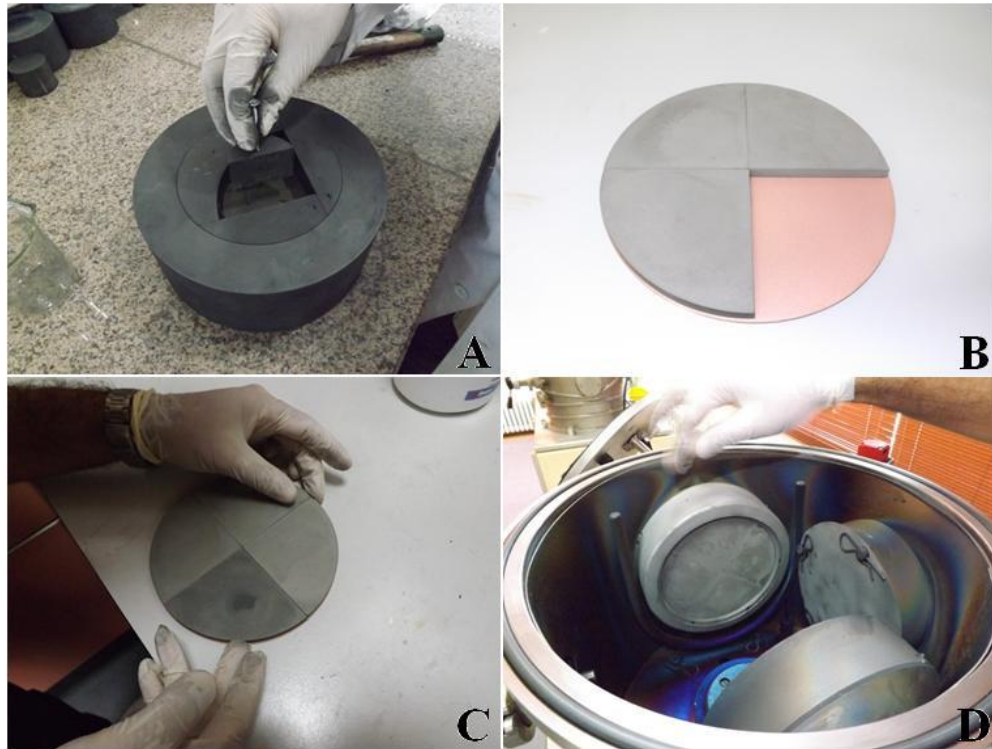
Şekil 6.14 : Ticari kalite TiB_2 tozlarından PVD hedef malzemenin hazırlanması ve DC magnetron sıçratma cihazına yerleştirilmesi (A: TiB_2 tozlarının grafit kalıba sinterlenmek üzere konulması, B: Sinterlenmiş TiB_2 çeyrek daireler, C: Sinterlenmiş TiB_2 çeyrek dairelerin bakır destek plakası üstünde birleştirilmesi, D: Hedef malzemenin PVD cihazına yerleştirilmesi).
