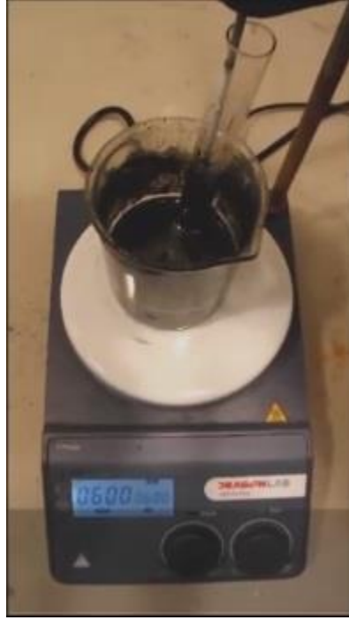
Şekil 6.12 : SHS ürünü TiB_2 tozlarının HCl liçi ile saflaştırılması.
