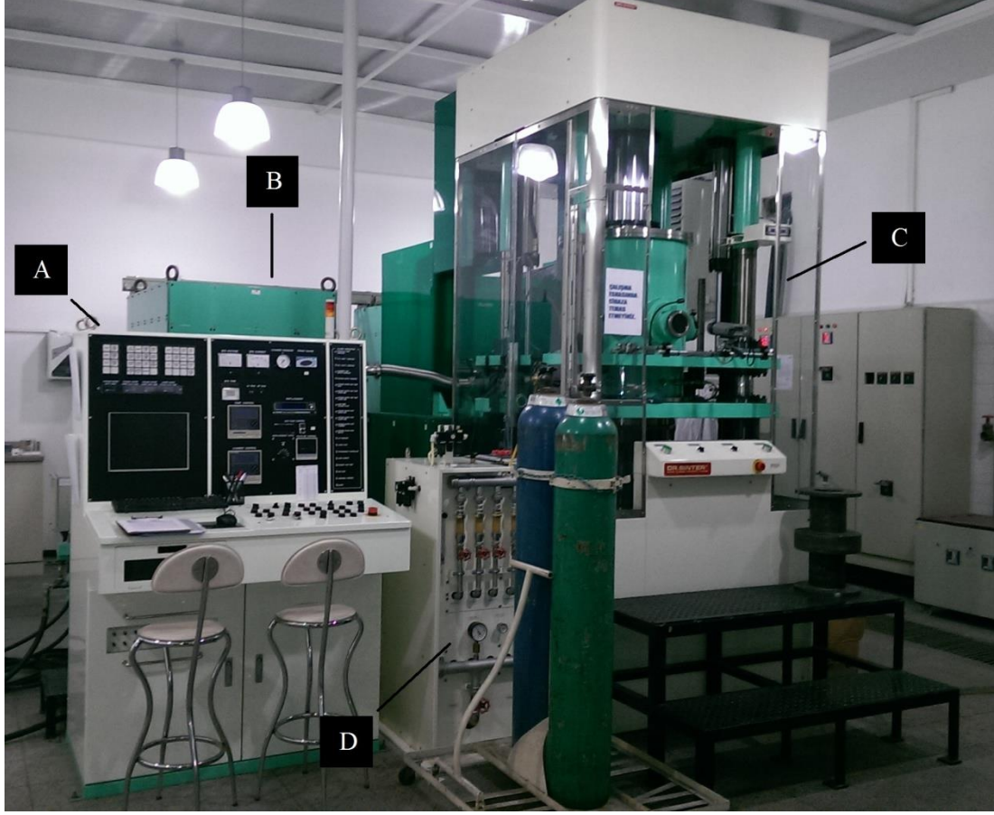
Şekil 6.7 : SPS çalışmalarında kullanılan SPS Syntex marka ve 7.40MK-VII model sinterleme cihazı (A: Proses kontrol ünitesi, B: DC elektrik jeneratörü, C: Sinterleme kamarası, D: Soğutma suyu, vakum ve gaz akışı kontrol ünitesi).
