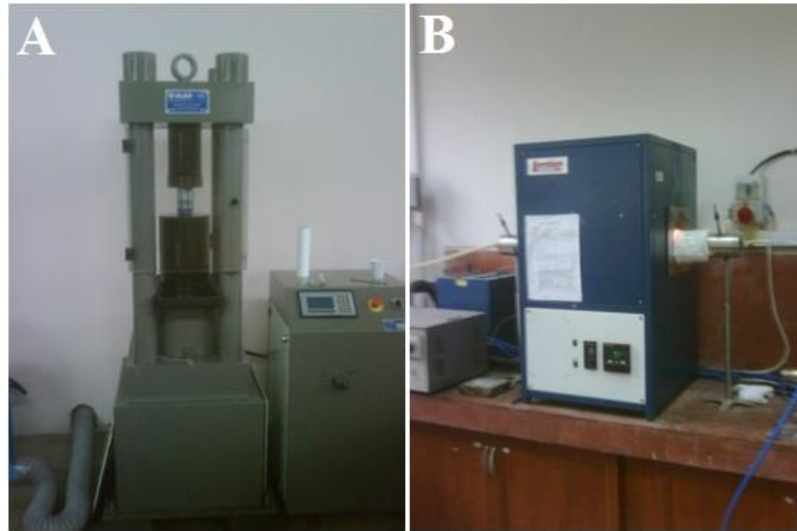
Şekil 6.9 : Basıncsız sinterleme deneyinde kullanılan soğuk izostatik pres (A) ve yüksek sıcaklık tüp fırını (B).
