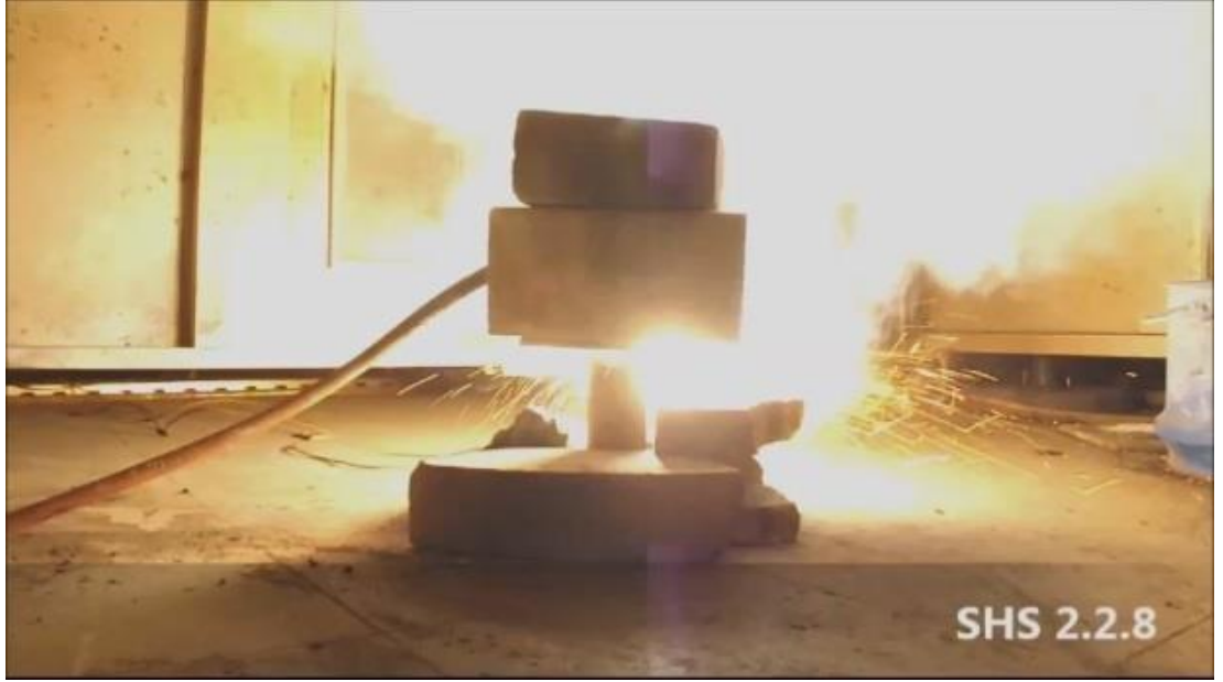
Şekil 6.11 : %100 Mg stokiometrisinde ve %5 \text{MgSO}_4 \cdot 7\text{H}_2\text{O} ilavesi ile Ar atmosferi altında gerçekleştirilen deneysel çalışmada reaksiyonun gerçekleşmesi.
