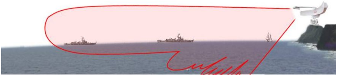
Şekil 2.30 : Kosekant – kare ışıma karakteristikli anten. (Şekilde ters kosekant – kare ışıma biçimi gösterilmektedir.)
