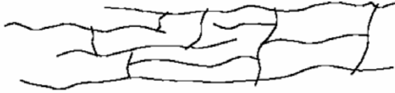
Şekil 2.4 : Termoset moleküllerin kür işlemi sırasında çapraz bağlanması.
