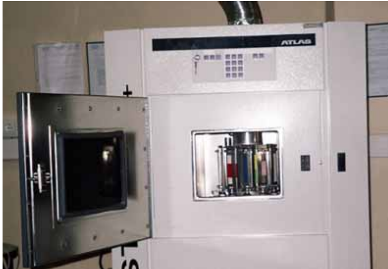
Şekil 4.10 : Ksenon ark lambası altında renk değişimi tespit cihazı (Özgenç, 2006).
