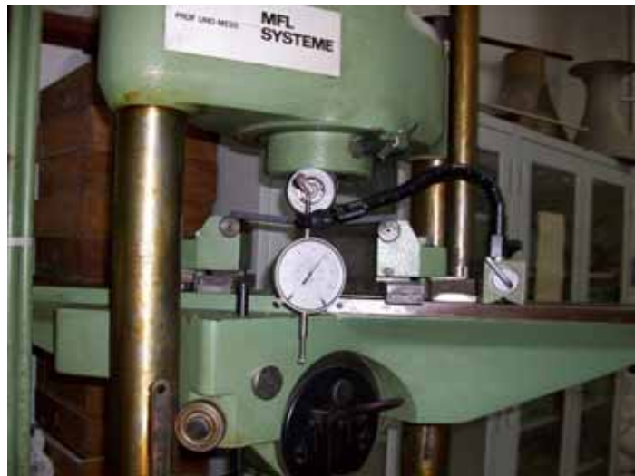
Şekil 6.7 : Eğilmede çekme dayanımı deneyi düzeneği.
