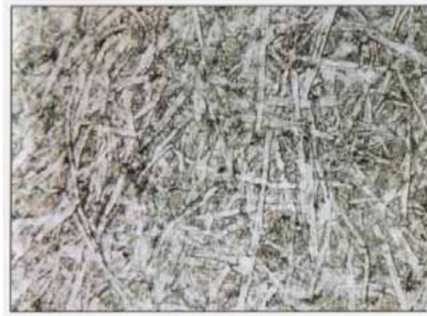
Şekil 5.6 : Melamin reçineli son katmanlı beyaz numunenin 3000 saatlik yapay yaşlandırma ve kirlenme testinden sonra büyütülmüş fotoğrafı.
