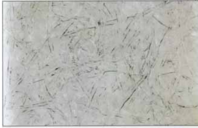
Şekil 5.7 : Melamin reçineli son katmanlı melamin numunenin 3000 saatlik yapay yaşlandırma ve kirlenme testinden sonra temizlenmiş yüzeyinin büyütülmüş fotoğrafı.
