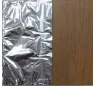
Şekil 7.15 : UV deneyi için yarı yüzeyi alüminyum folyo ile kaplanan numune.
