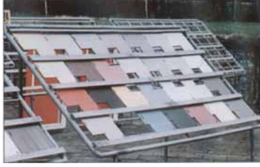
Şekil 5.8 : HPL tabakalarının Delft'teki TNO istasyonunda dış hava etkilerine maruz bırakılması.
