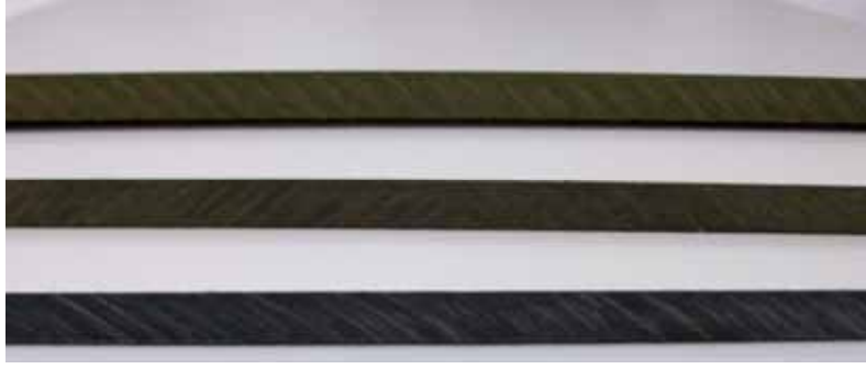
Şekil 6.5 : Klimatik şok deneyinden sonra HPL'nin iç tabakasında görülen sarıma.
