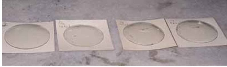
Şekil 4.2 : Lekelenmeye dayanıklılık deneyi uygulaması (Özgenç, 2006).
