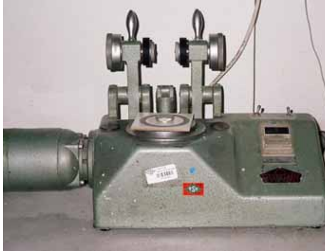
Şekil 4.9 : Yüzey aşınma dayanımı test aleti (Özgenç, 2006).
