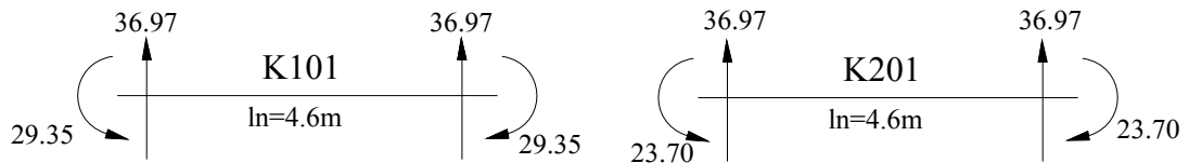
Şekil 5.9 : Düşey Yükler Altında Kirişlerde Oluşan İç kuvvetler
