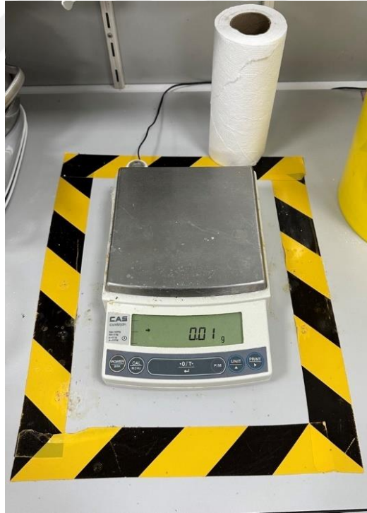
Şekil 4.11 : Nem ölçümünde kullanılan hassas terazi ve havlu kağıt.
