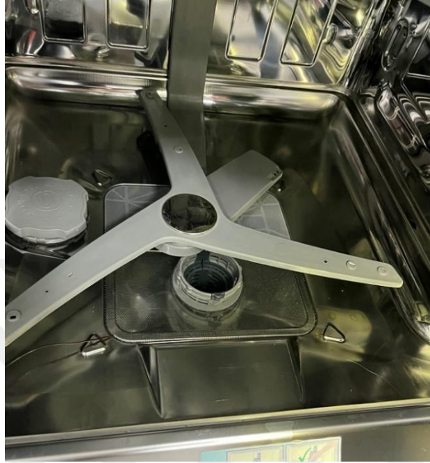
Şekil 4.26 : Kabin zemininde oluşan su yüzeyi.
