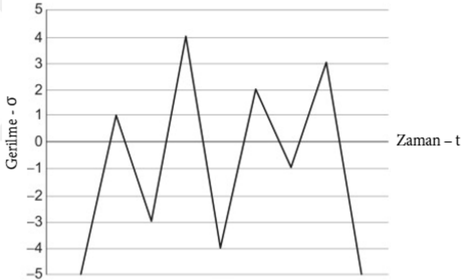
Şekil 2.7 : Değişken yüklemeye sahip sistemin gerilme zaman grafiği.
