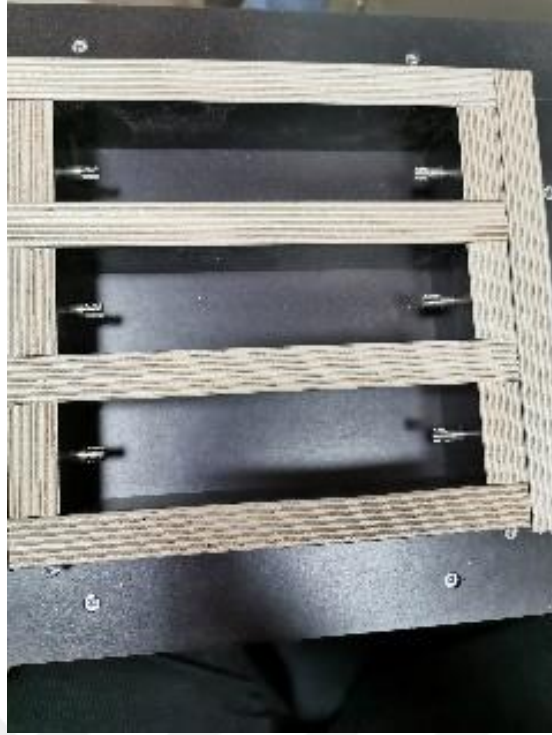
Şekil 3.6 : Serbest rötre numuneleri için pimli kalıp.
