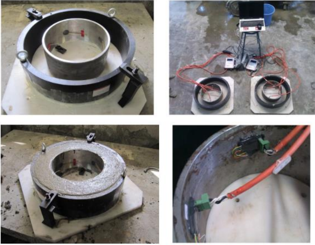
Şekil 2.4 : Gerinim ölçme tekniği kullanılarak teşkil edilen kısıtlanmış rötre deney düzeneği (Yousefieh ve diğ, 2017).
