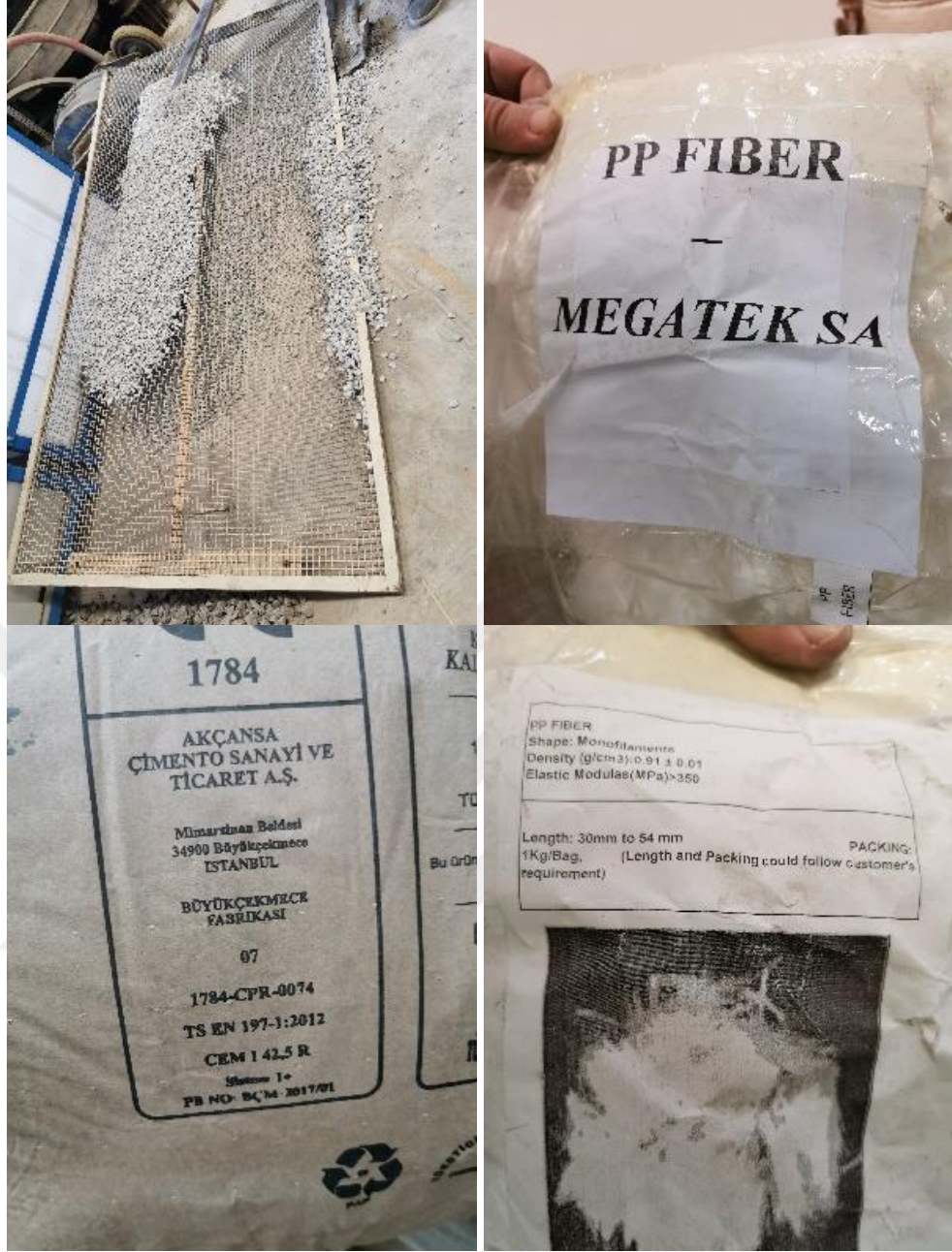
Şekil 3.4 : Kullanılan malzemelere ait görseller; agrega, mikro fiber, makro Fiber, çimento.
