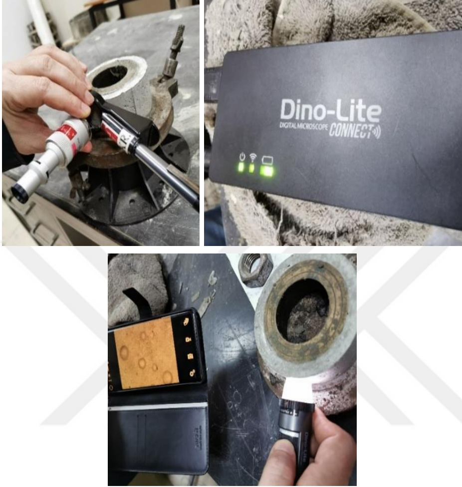
Şekil 3.19 : Harç numunede meydana gelen kısıtlanmış rötre çatlaklarının ölçümü.
