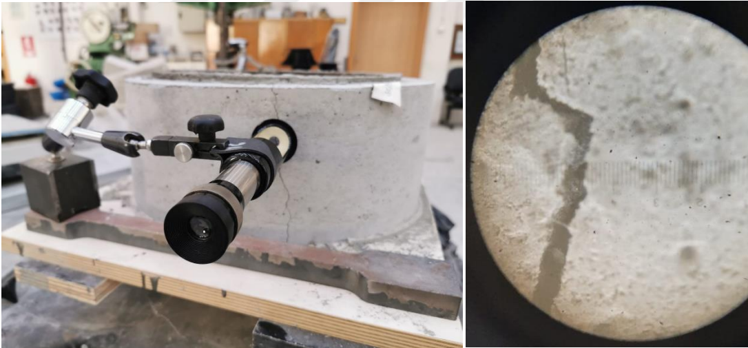
Şekil 3.13 : Mikroskop vasıtasıyla ölçülen çatlak genişlikleri.
