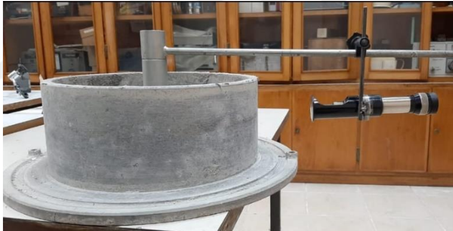
Şekil 3.11 : ASTM C1581 standardına uygun beton kalıbı ve portatif mikroskop.
