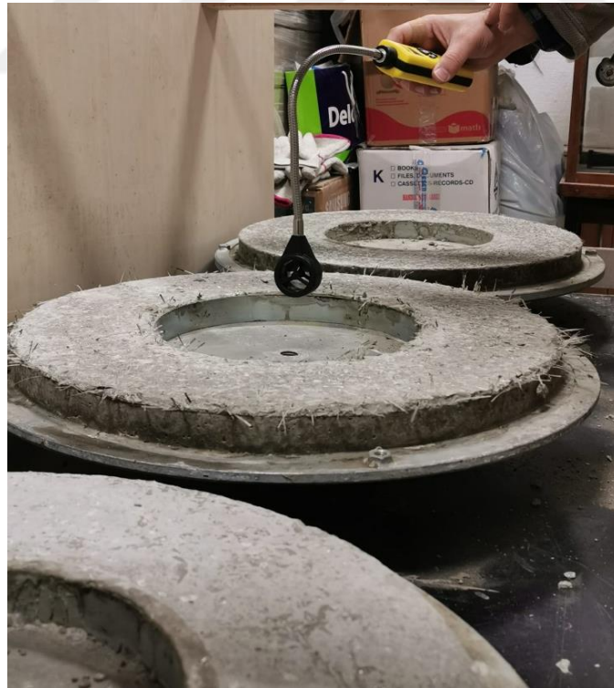
řekil 3.15 : R zg r hızının anemometre ile  l  lmesi.
