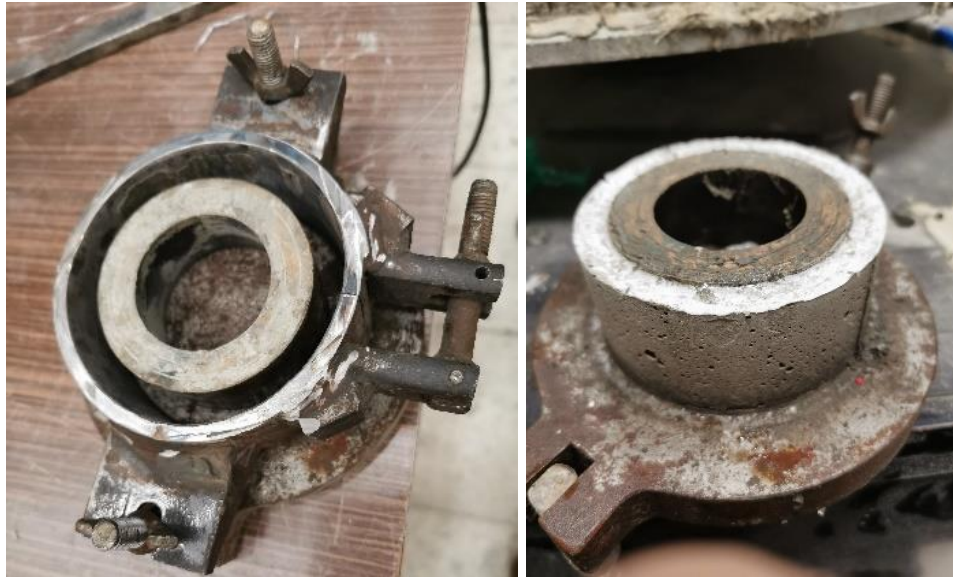
Şekil 3.18 : Harç numuneler için kısıtlanmış rötre numuneleri.
