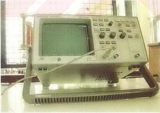
Şekil C.17 Dijital osiloskop (band genişliği 100 MHz)
