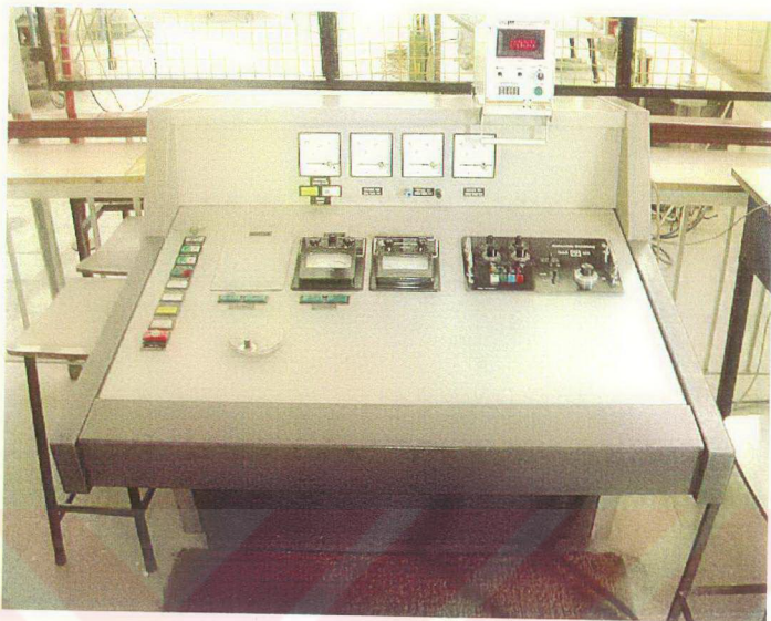
Şekil C.12 Darbe üreticinin kumanda masası
