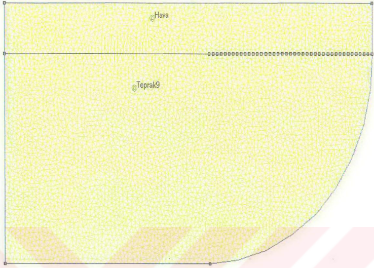
Şekil 5.22 25 m uzunluğundaki şerit topraklayıcının potansiyel dağılımı için kapalı bölgenin üçgen elemanlara ayrılması
