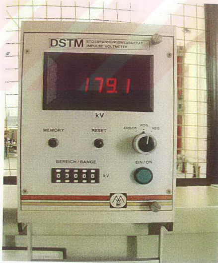
Şekil C.13 Darbe tepe değeri voltmetresi
