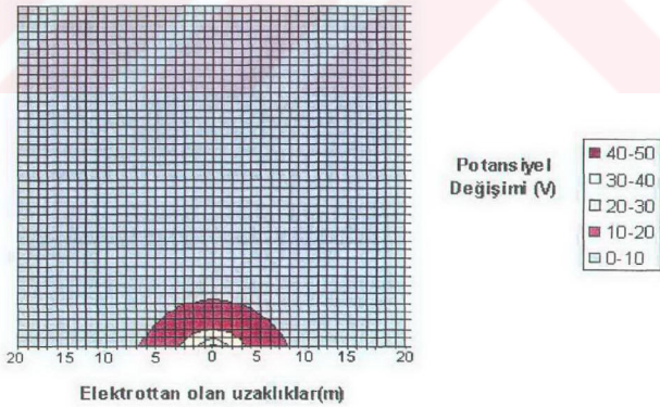
Şekil 6.7 5 m uzunluğundaki şerit topraklayıcının üç boyutlu hesaplamalarla bulunan potansiyel dağılımının üstten görünüşü
