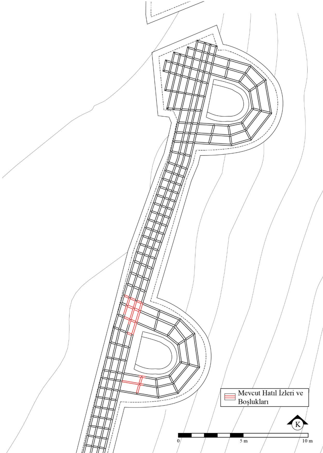
Şekil 5.3 : Kule 4-Kule 5 arası temeldeki hatıl sistemi planı önerisi 2 (Kaymak, 2023)
