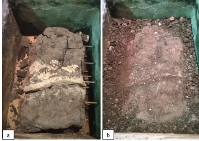
Şekil 3.12 : a) Küçük reaktör deneyinden kömür bloğu örneği. b) Reaktördeki boşlukların kömürle doldurulması.
