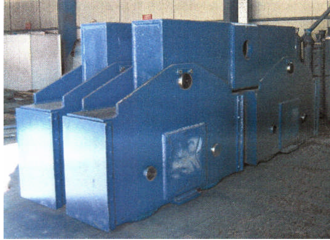
řekil 3.2: İki Adet Kk Denge Kiriřinin Boji Montajı Hali
