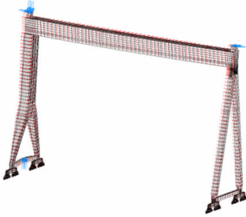
Şekil B.8 : Tambur Yükünden Dolayı Oluşan Deformasyon
