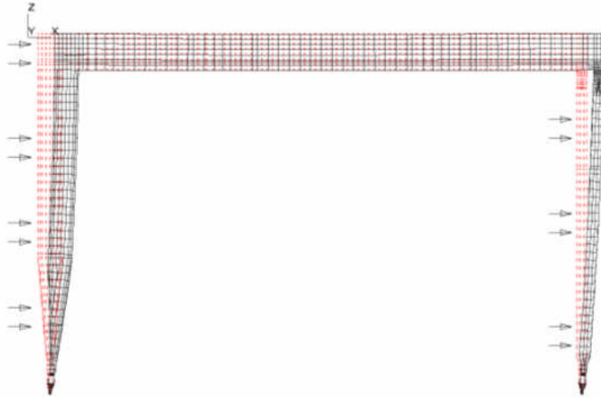
Şekil B.6 : X –Ekseninde Rüzgar Yükünden Dolayı Oluşan Deformasyon
