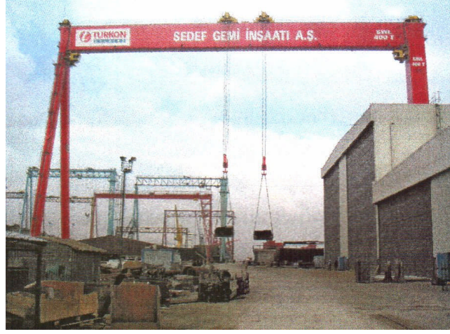
Şekil 3.15: Portal Krenin Bacaklar Arasında % 140 Yükle Dinamik Testi
