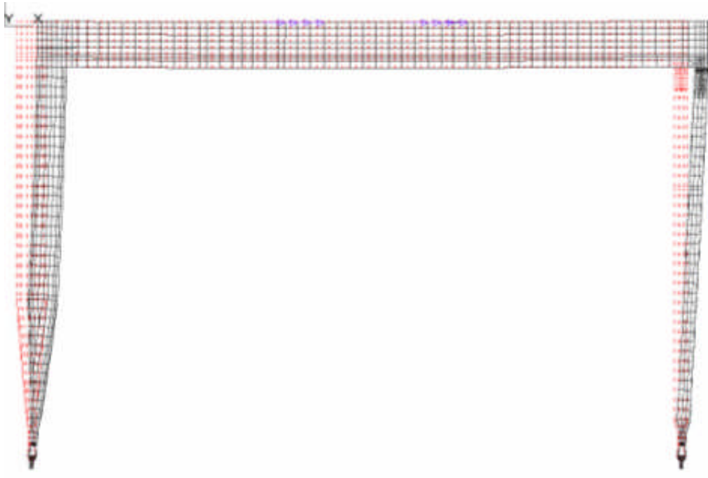
Şekil B.4 : 2. Pozisyonda Arabanın X- Eksenindeki Yatay Yüklenmesinden Dolayı Oluşan Deformasyon
