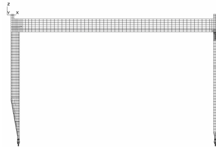
Şekil 9.3 : Krenin Genel Ağ Yapısı Önden Görünüm
