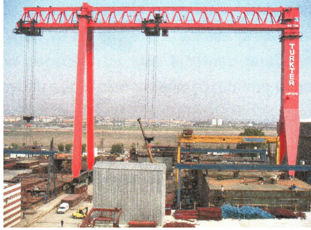
Şekil 3.16: Portal Krenin Konsol Ucunda % 140 Yükle Dinamik Testi
