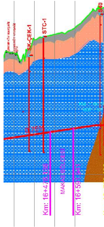
Şekil 4.3 : Çekmeköy makas bölgesinde beklenen jeoloji [19]
