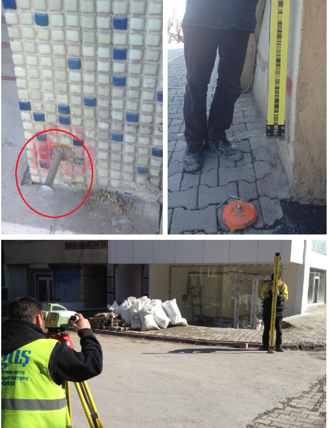
Şekil 5.4 : Yüzey deformasyon bulonu okumaları
