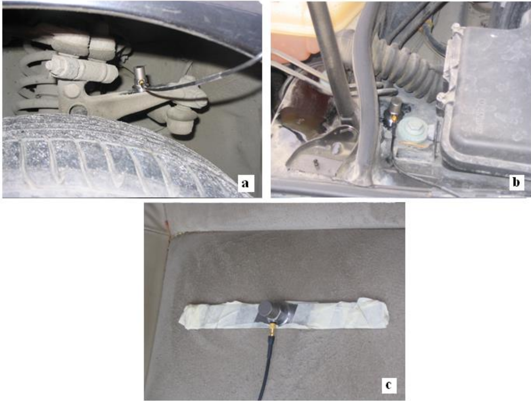
Şekil 6.6: Otomobilin farklı bölgelerine yerleştirilen ivmeölçerler: (a) Aks (b) Gövde (c) Koltuk
