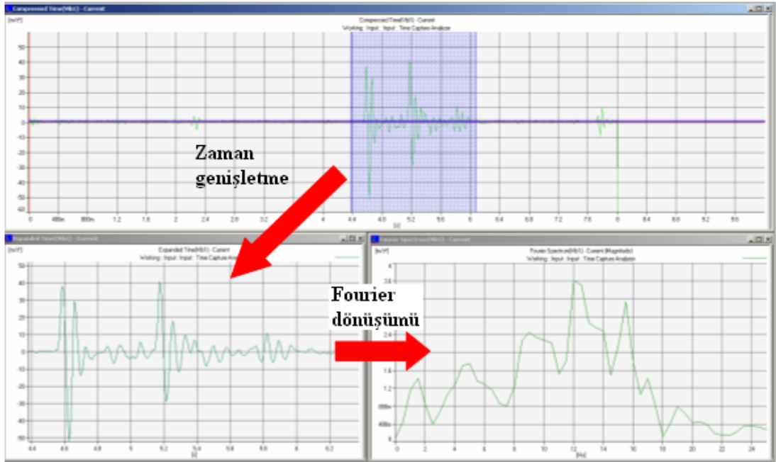
Şekil 6.10: İvme değişimi üzerinde sırayla zaman genişletme ve Fourier dönüşümü analizörlerinin uygulanışı
