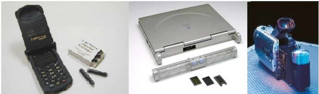
Şekil 2.9 : Taşınabilir cihazlarda yakıt pili uygulamaları.
