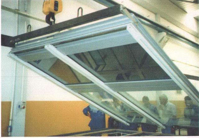
Şekil 3.9 İş Bankası Panelinin tamamlanmış ve son imalat tezgahından kaldırılırken görünümü
