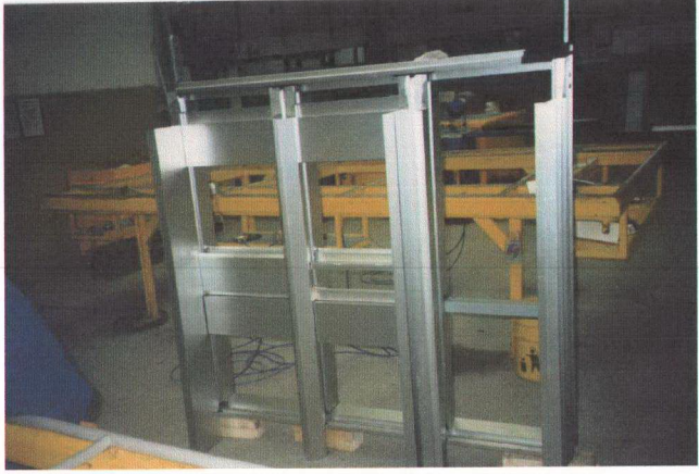
Şekil 3.8 İş Bankası Paneli çerçeve profillerinin birleştirilmiş görünümü
