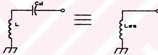
Şekil 4.5. Tranzistor girişindeki eşdeğer endüktans devresi.
