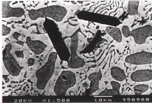
Şekil 4.32 a) ZA/38(%0,026 Mn), b) ZA/41(%0,09 Mn) ve c) ZA/46(%0,53 Mn) alaşımlarının SEM mikroyapıları
