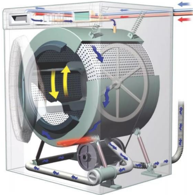
řekil 1.33 : amařır makinesinin alıřması sırasında su hareketi [21].
