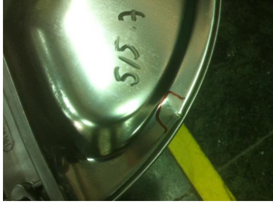
Şekil 1.55 : Test sonucunda meydana gelen yırtılma [31].
