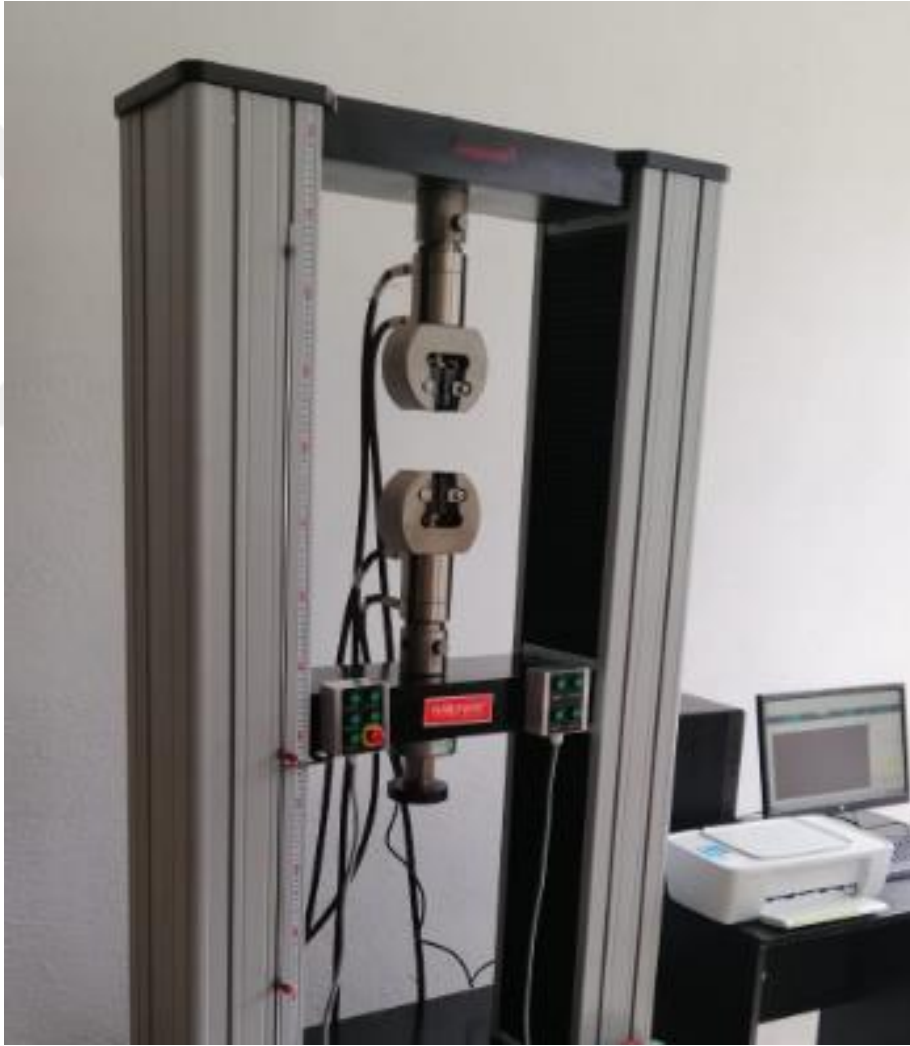
Şekil 4.3 : Numune örneği ve çekme deney cihazı.
