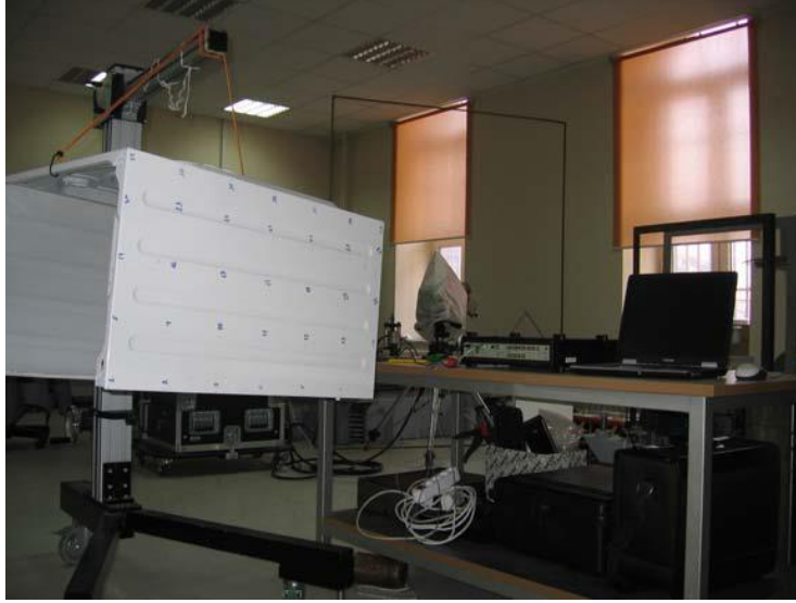
Şekil 1.43 : Çamaşır makinesi gövdesinin ölçüm noktaları ve deney düzeneği [27].
