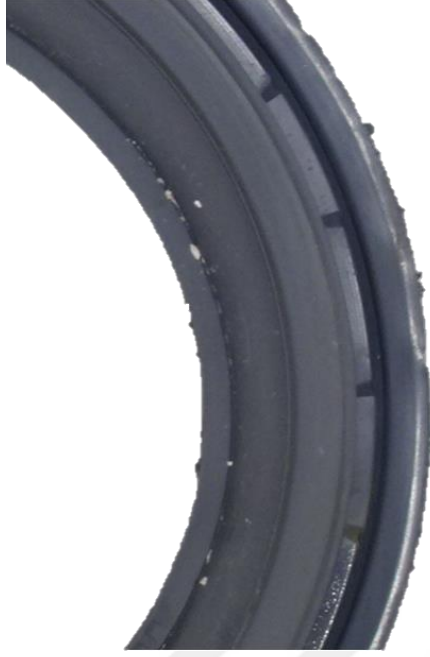
Şekil 5.6 : Körük test sonu saat 9 yönündeki bölgesi
