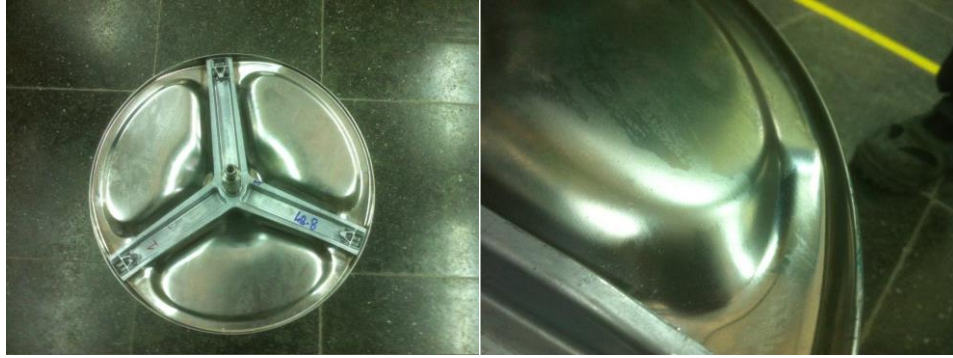
Şekil 1.56 : 0.5 mm tambur arka sacı ile üretilmiş tambur numunesi [31].
