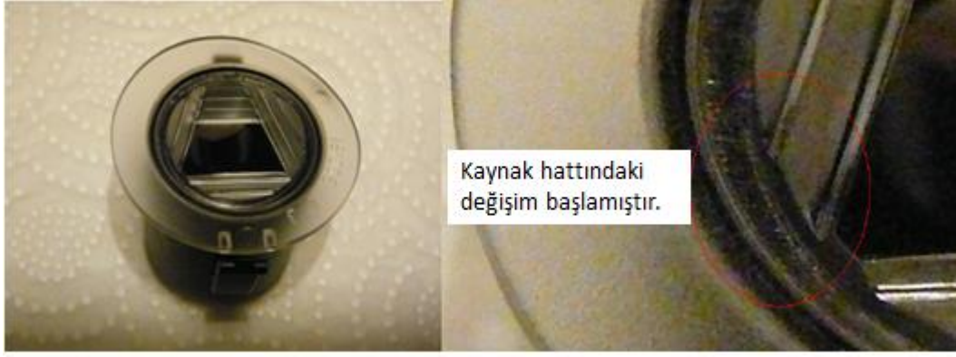
Şekil 1.63 : Araç içi aydınlatma lambasında yapılan deneme örneği [36].
