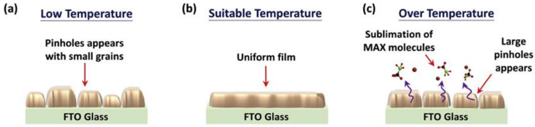
Şekil 2.36 : Perovskitin düşük, uygun ve yüksek sıcaklarda tavlanması sonucu oluşan film morfolojisinin gösterimi [76].
