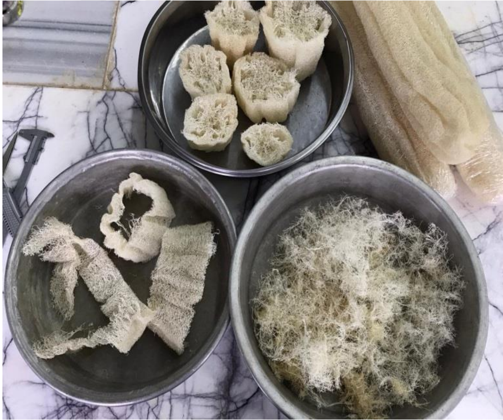
Şekil 3.12 : Su kabağı ( Luffa Cylindrica ) liflerinin doğadan elde edildiği hali (üstte), çekirdekleri çıkartılmış hali (solda) ve liflerin kompozit için parçalanmış hali (sağda).
