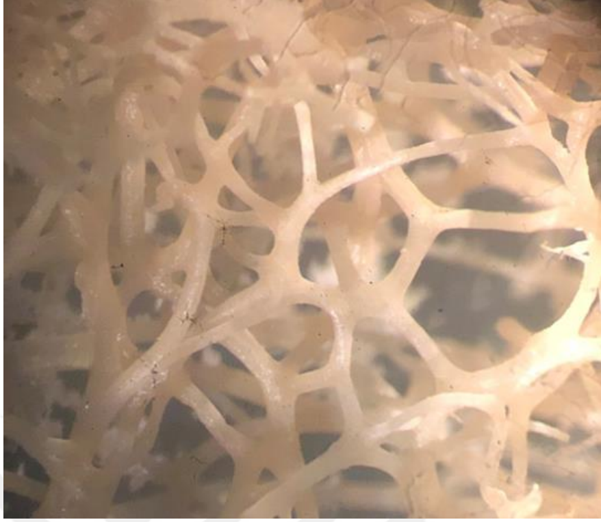
Şekil 3.14 : Kaynar suda bekletilmiş su kabağı ( Luffa Cylindrica ) liflerinin dokusunun mikroskop görüntüsü.
