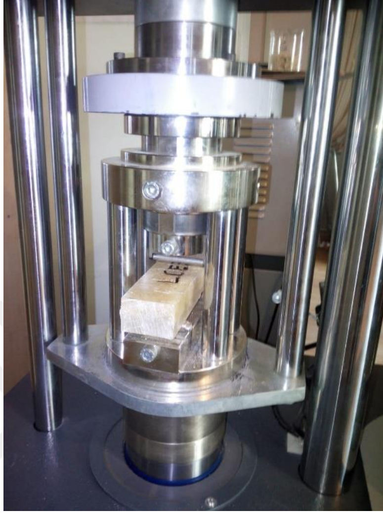
Şekil 4.18 : 3 noktalı bükme test makinesi ile eğilme dayanımı ölçümü.
