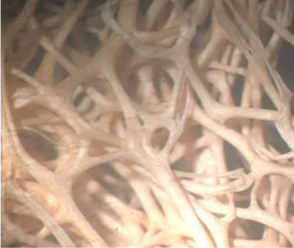
Şekil 3.13 : Ağartma işlemi öncesinde su kabağı ( Luffa cylindrica ) liflerinin dokusunun mikroskop görüntüsü.
