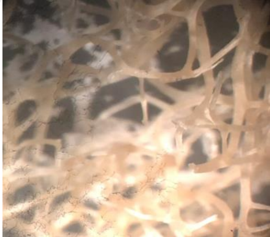
Şekil 3.15 : 2 saat süresince %1'lik NaOH çözeltisinde bekletilerek ağartma işlemi uygulanmış su kabağı ( Luffa Cylindrica ) liflerinin dokusunun mikroskop görüntüsü.
