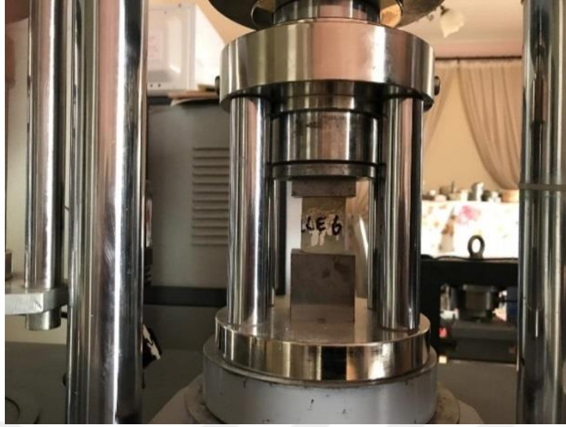
Şekil 4.20 : Numunelerin laboratuvar ortamında basınç testine tabi tutulması.
