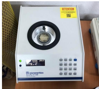
Şekil 3.20 : Helyum piknometre ile su kabağı liflerinin yoğunluk tayini.
