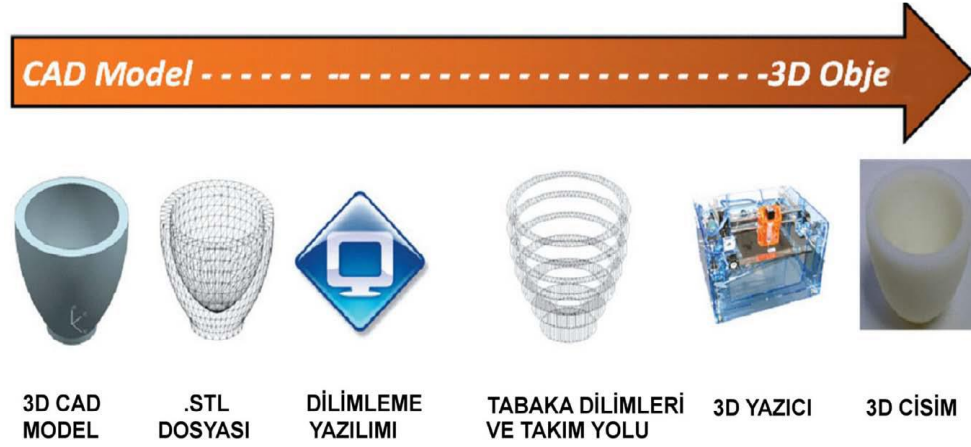
Şekil 3.17 : 3Ds yazıcı ile imalat akış süreci (Dvorak vd., 2018).
