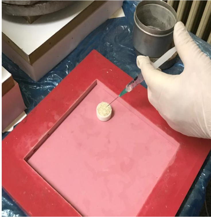
Şekil 3.22 : El ile yayma yöntemi ile üretilen su kabağı (LC) lifi-epoksi kompozit numunelerine epoksi enjekte edilmesi.
