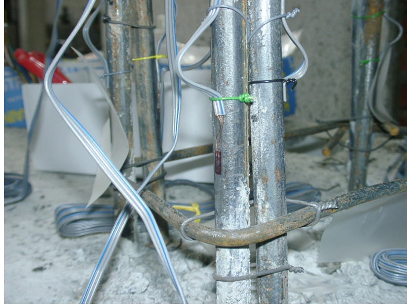
Şekil 4.5 Numunede kullanılan Strain-gauge örneği
