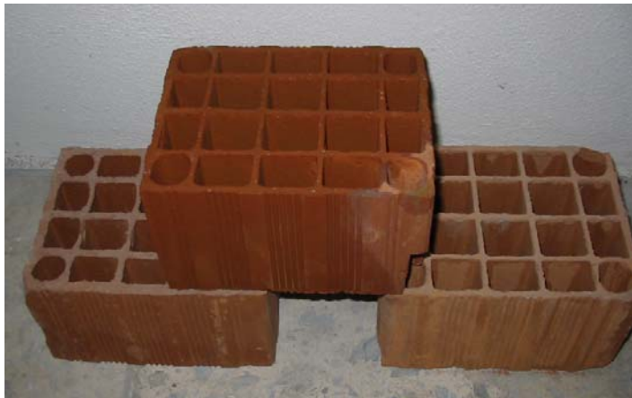
Şekil 4.9 Dolgu Duvarda Kullanılan Tuğla Tipi
