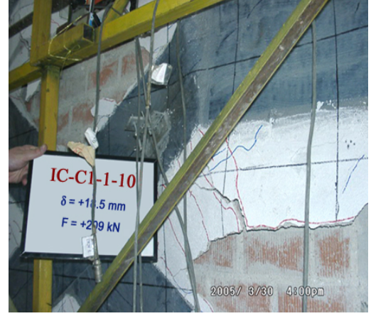
Şekil 4.46 Sıva Kabarması ve Karbon Lif Çaprazının Burkulması (Ön Yüz)
