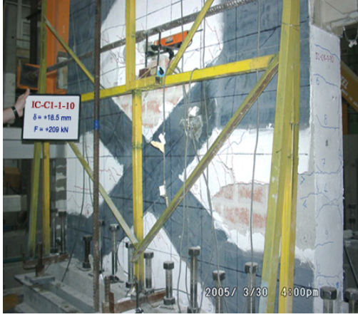
Şekil 4.46 Sıva Kabarması ve Karbon Lif Çaprazının Burkulması (Ön Yüz)
