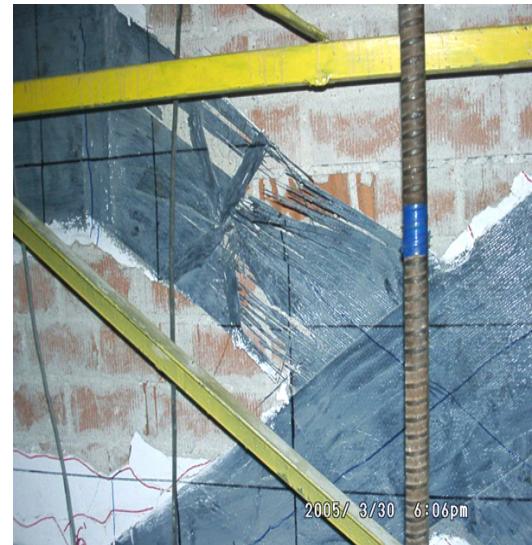
Şekil 4.49 2 No' lu Karbon Lifi Çaprazının Burkularak Kopması (Ön Yüz)
