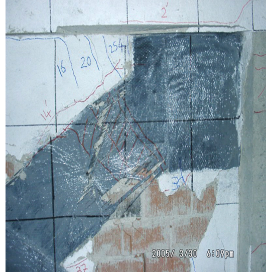
Şekil 4.50 2 No' lu Karbon lif Çaprazının Burkularak Kopması (Arka Yüz)
