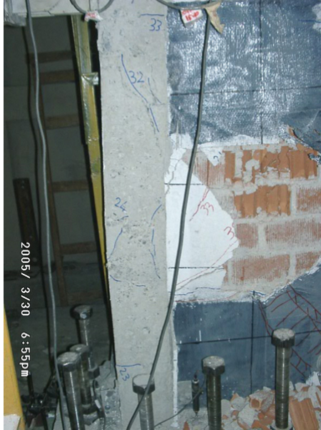
Şekil 4.51 Kolonlarda Meydana Gelen Çatlaklar ve Eğilmeler (Arka Yüz Sol Kolon)
