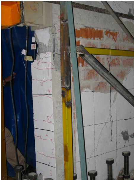
Şekil 4.34 Çerçeve Meydana Gelen Mafsallařma ve Donatı Akması
