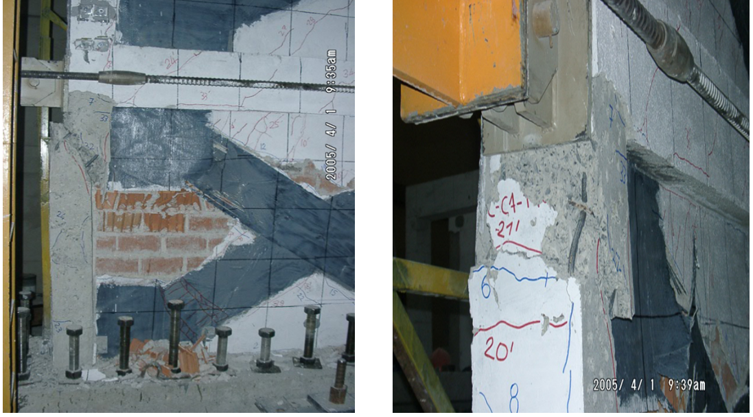
Şekil 4.52 Arka Yüz Sol Kolonda Kesilme ve numunede eğrilme
