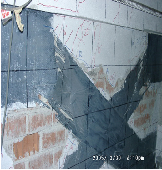
Şekil 4.50 2 No' lu Karbon lif Çaprazının Burkularak Kopması (Arka Yüz)
