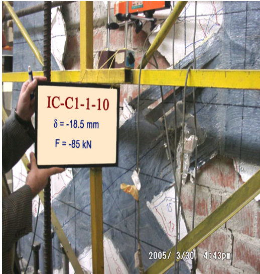
Şekil 4.47 1 No' lu Karbon Lifi Çaprazının Burkularak Kopması (Ön Yüz)
