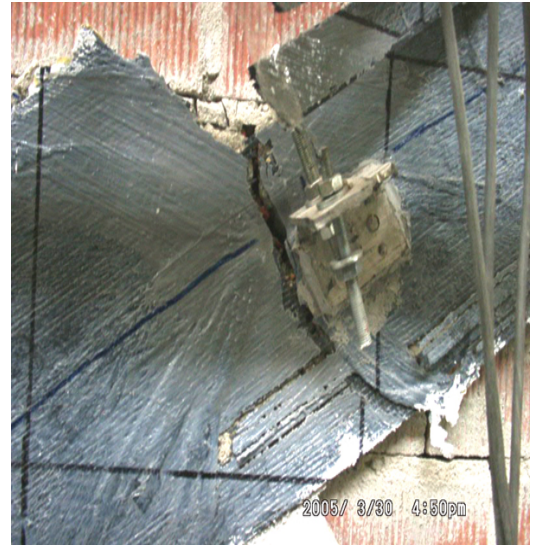
Şekil 4.47 1 No' lu Karbon Lifi Çaprazının Burkularak Kopması (Ön Yüz)
