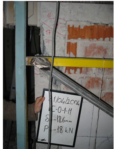
Şekil 4.34 Çerçeve Meydana Gelen Mafsallařma ve Donatı Akması
