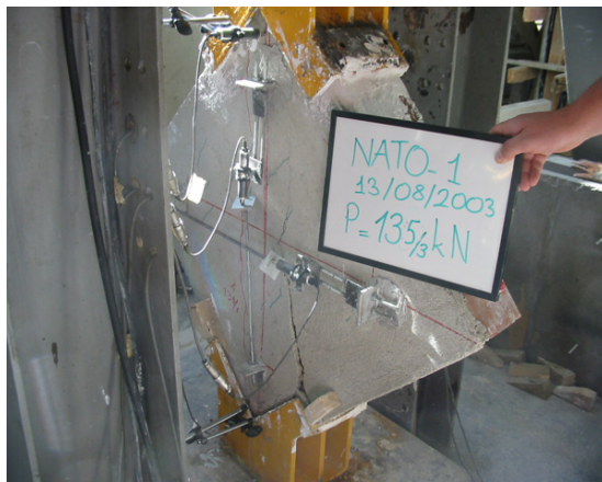
řekil 4.18 Numunede Meydana Gelen Çatlaklar
