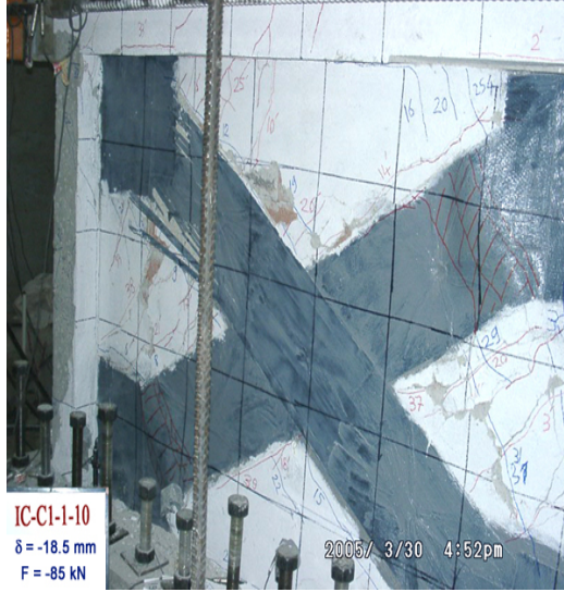
Şekil 4.48 1 No' lu Karbon Lifi Çaprazının Burkularak Kopması (Arka Yüz)
