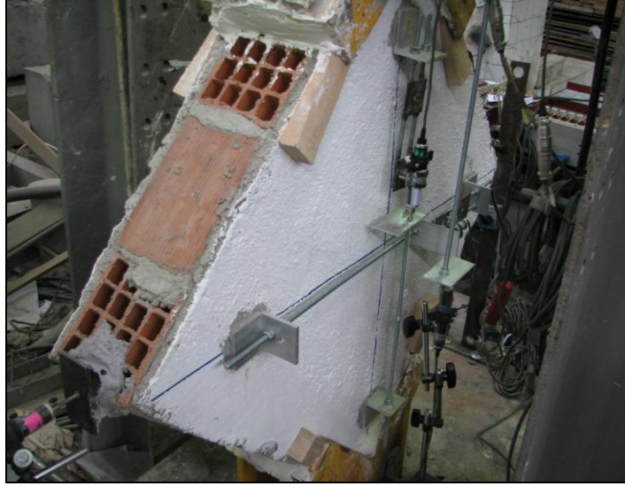
Şekil 2.17: Yerdeğiştirme ölçerler (LVDT).
