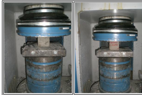
Şekil 3.21: Dolgu duvarlı betonarme çerçevelerin güçlendirilmesinde kullanılan CMG harcı basınç deneyleri.
