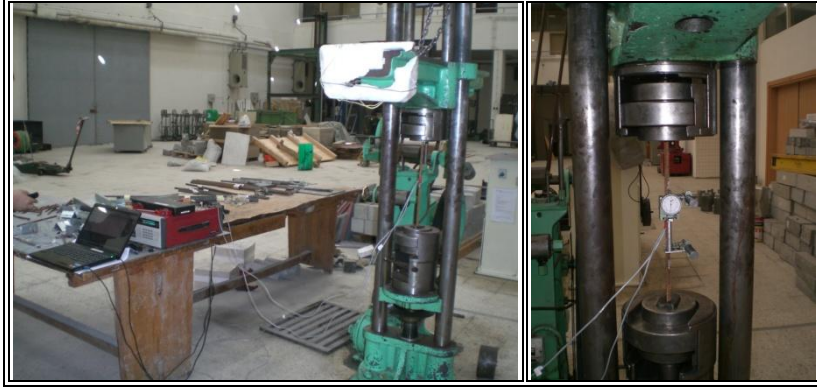
Şekil 3.17: Standart donatı çekme deneylerinde kullanılan düzenek.
