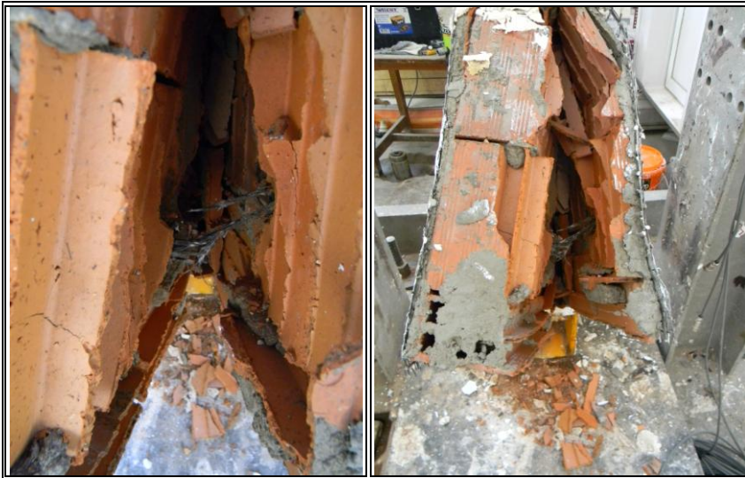
Şekil 2.32: S-2-2-2 numunesinde göçme anında kopan ankrajlar.
