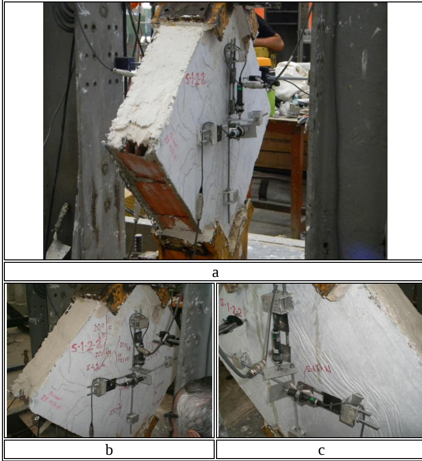
Şekil 2.37: S-1-2-2 numunesi a) deney düzeneği, b) ön (güçlendirilmemiş) yüzdeki çatlaklar ve c) arka (güçlendirilmiş) yüzdeki çatlaklar.
