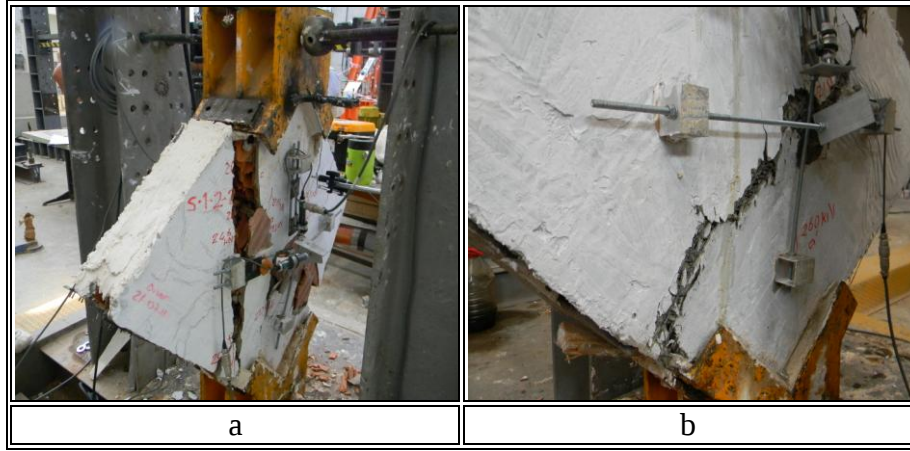
Şekil 2.38: S-1-2-2 numunesinin göçme sonrası durumu a) ön (güçlendirilmemiş) yüz, b) arka (güçlendirilmiş) yüz.
