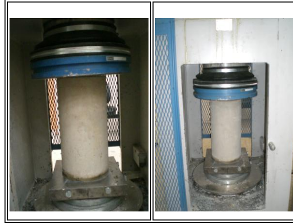
Şekil 2.13: Dolgu duvar numunelerinin üretiminde kullanılan beton harcı standart basınç deneyleri.
