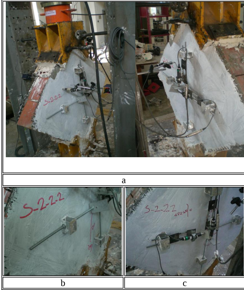
Şekil 2.31: S-2-2-2 numunesi a) deney düzeneği, b) ön yüzdeki çatlaklar ve c) arka yüzündeki çatlaklar.
