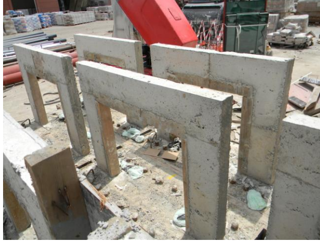
Şekil 3.2: Üretilen betonarme çerçeve numuneleri.
