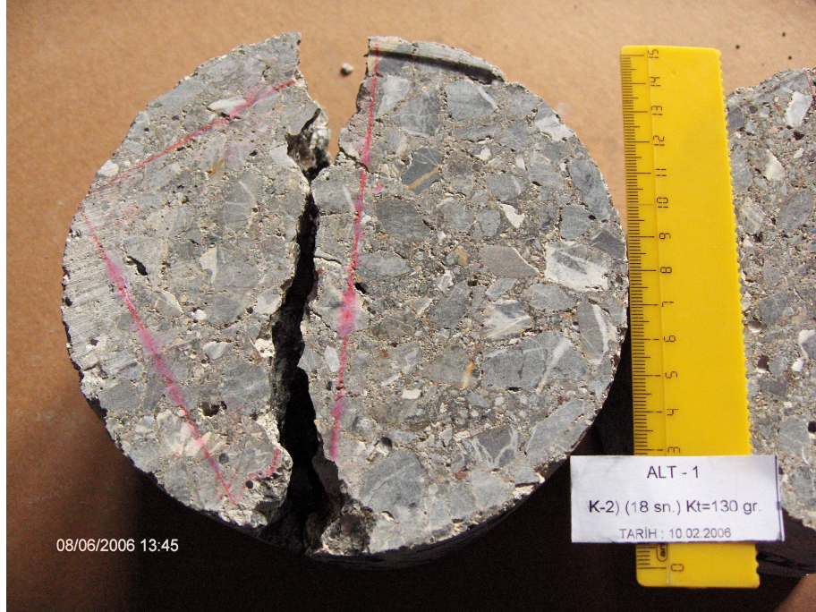
Şekil C.3: K2-18-130 Kodlu Numunenin Alt Diskinin Yarma-Çekme Deneyi Sonrası Görünüşü
