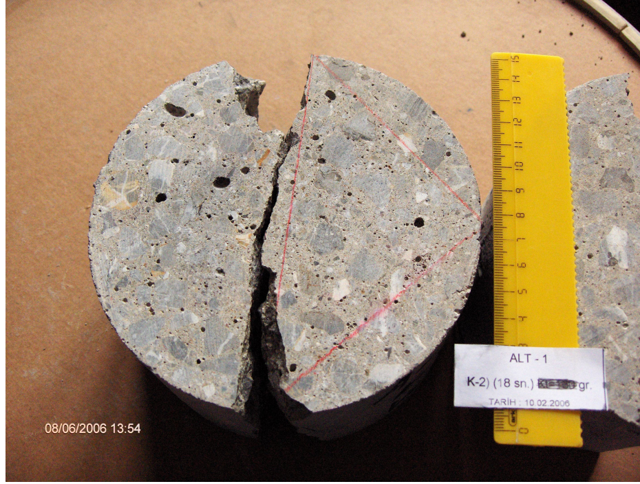
Şekil C.2: K2-18-65 Kodlu Numunenin Alt Diskinin Yarma-Çekme Deneyi Sonrası Görünüşü
