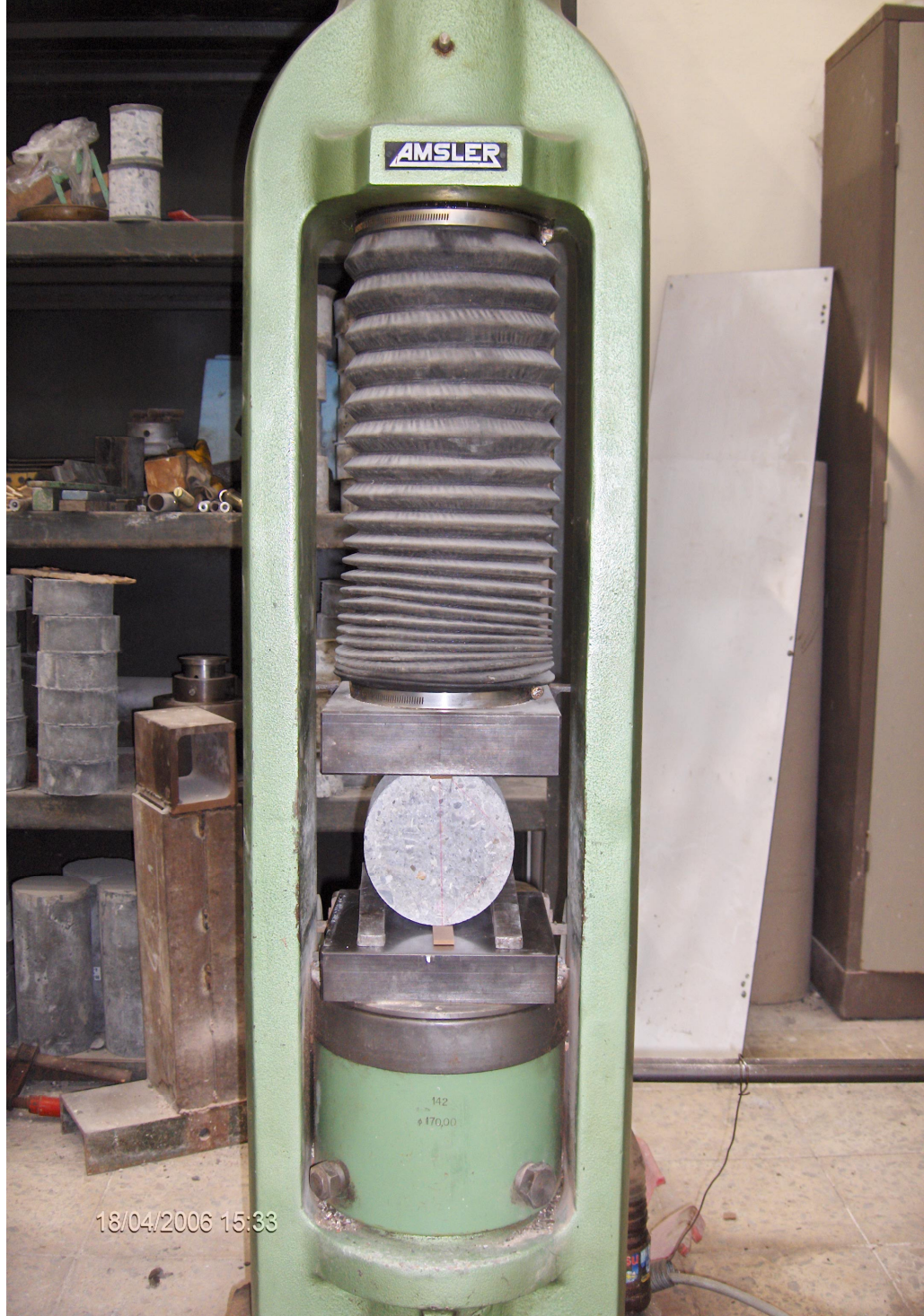
Şekil C.1: Yarma-Çekme Deneyi Düzeneği
