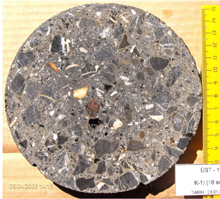
Şekil 4.2: K1-18-60 Kodlu Numunenin Üst Yüzeyi
