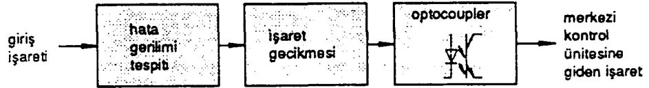
Şekil 3.124. Bir giriş modülünün blok şeması.
