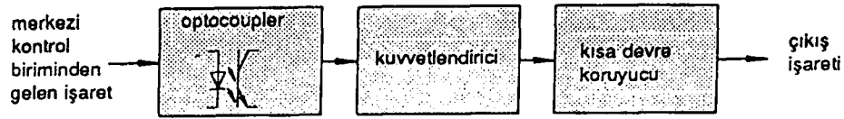
Şekil 3.125. Bir çıkış modülünün blok şeması.
