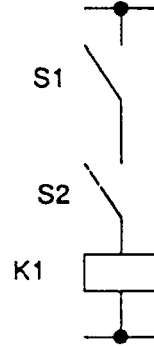
Şekil 3.99. Elektrik röleli kontrol.
