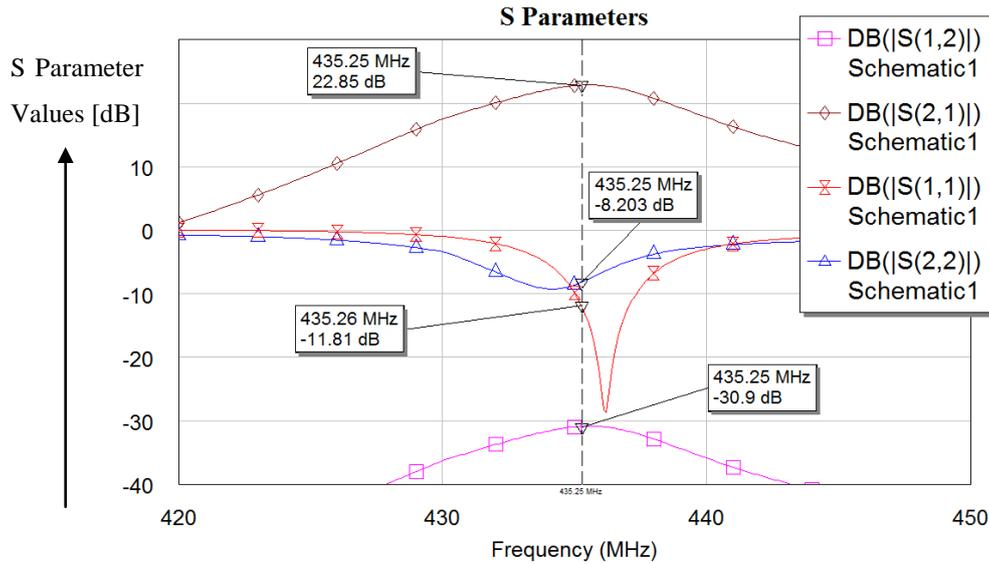
**Figure 2.30** : The S parameters graph.
