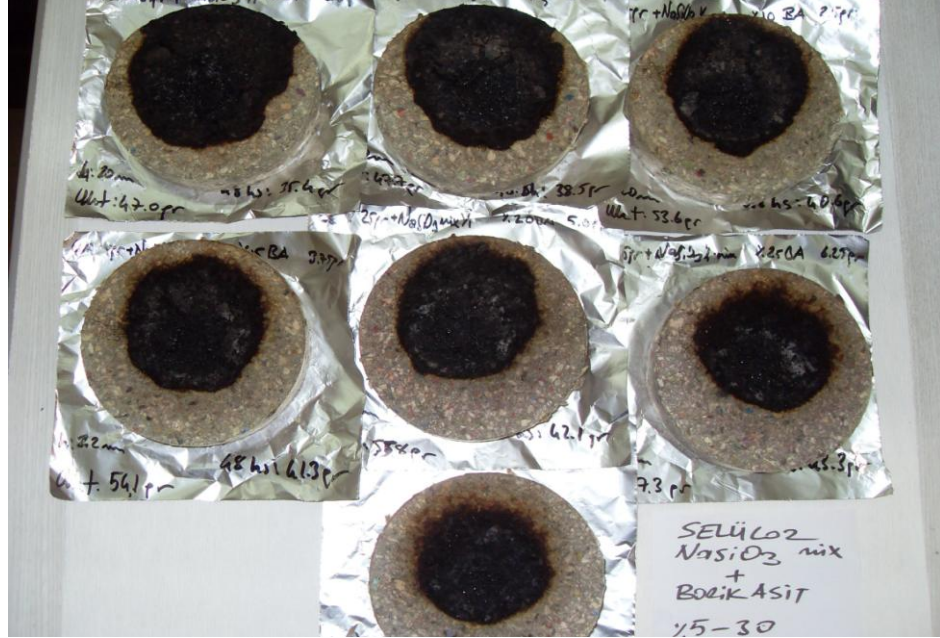
Şekil 4.14 : Borik asit+ su ve Borik asit+ \text{Na}_2\text{SiO}_3 bağlayıcılı olarak hazırlanmış sıkıştırılmış selüloz numunelerinin, 5 dakikalık yanma testi sonrası görüntüleri.
