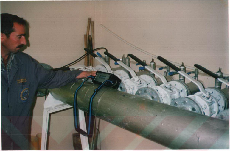
Şekil D.8 Yakacık Açık Depo Sahası Depo Gazı Numune Alma Noktalarının Ve Seyyar Gaz Ölçüm Cihazının Görünümü
