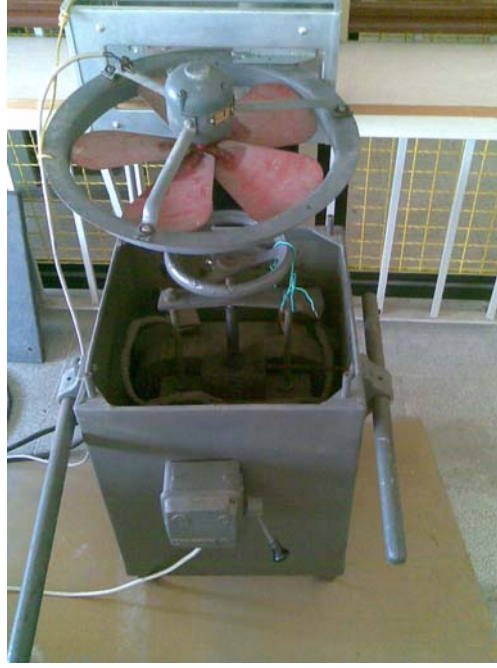
Şekil A.1: 230 V, 10,5 kVA, Tek Fazlı Giriş – Tek Fazlı Çıkışlı Trafo
