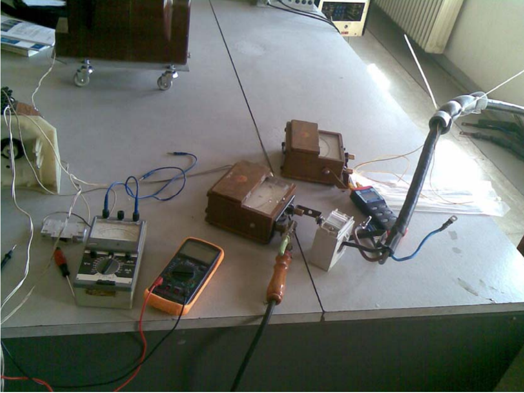
Şekil A.5: NYY 1 x 25 mm 2 0,6/1 kV Kablo, Akım Ölçü Trafosu, Analog Ampermetre, Dijital Ampermetre ve Termokupl Cihazının Deney Sırasındaki Çekilmiş Fotoğrafi
