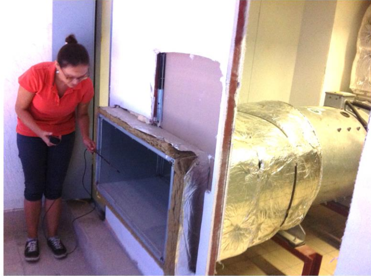
Şekil 4.12 : Ölçme yöntemi için fan emiş ağzında hız ölçümleri.
