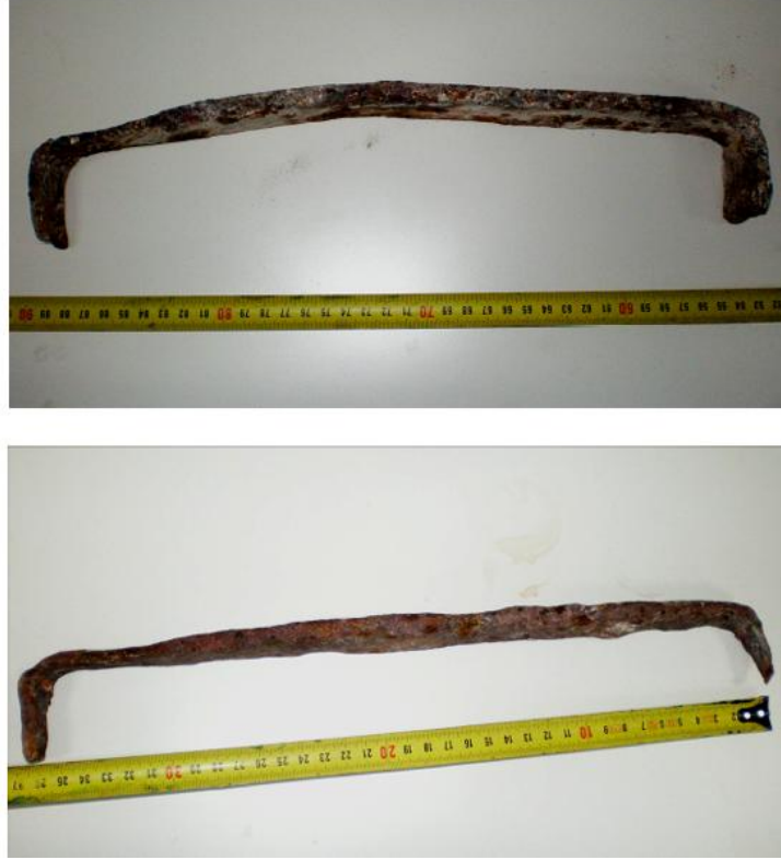
Şekil 3.26 : Edirne II. Beyazid Cami’den alınan kenetler (Demir, 2012).
