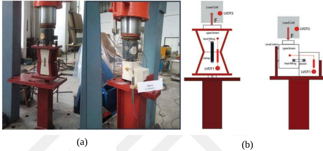
Şekil 2.20 : İki tür numune için test modeli, (a) enstrümantasyon, (b) kurulum şeması( Nikolić ve diğ., 2020).
