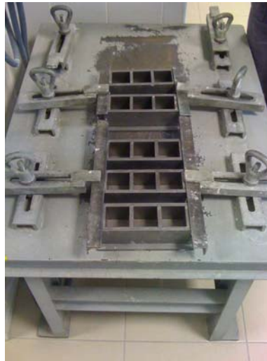
Şekil 4.11: Malzemenin döküm yapılacağı 50x50x50 mm’lik kalıplar.
