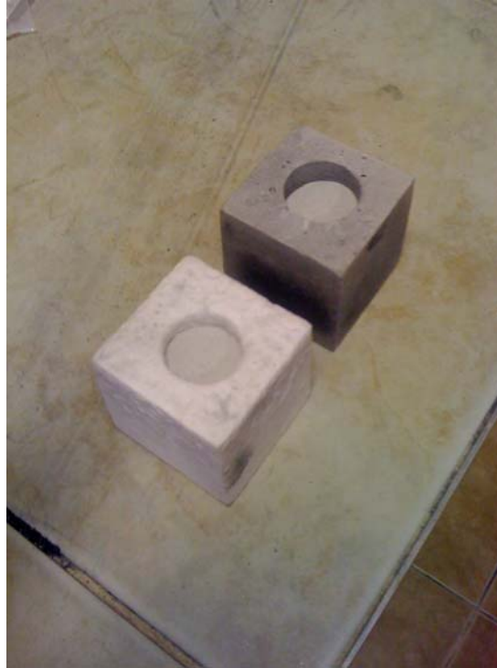
Şekil 4.19: Curuf Deneylerinde kullanılacak olan biri hava diğeri indirgen ortamında sinterlenmiş 25x25x25 mm ölçülerinde silindirik boşluk bulunan, dış ölçüleri 50x50x50 mm ebatlarında olan küpler.
