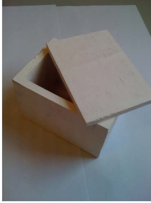
Şekil 4.13: Grafit içersine konulacak numuneler için sinterleme kutusu.
