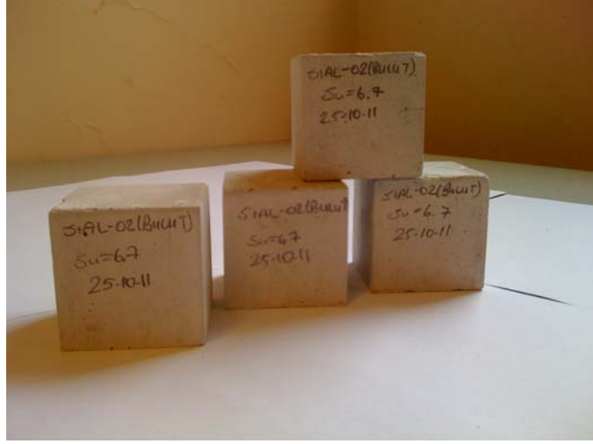
Şekil 4.15: 1500 0 C’de 2 saat sinterlenmiş küpler.
