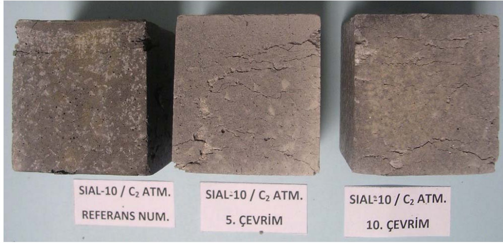
Şekil 5.18: İndirgen ortamda ısıtıl işlem gören numunlerin termal şok testi sonrası basma mukavemet test sonuçlarına ait görüntü.
