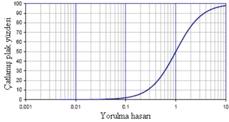
Şekil 8.4: Derzli donatısız tipteki rijit üstyapılarda yorulma hasarı ile çatlamış plak yüzdesi arasındaki ilişki [15]
