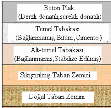
Şekil 8.3: Olası üstyapı tabaka sisteminin gösterimi [15]
