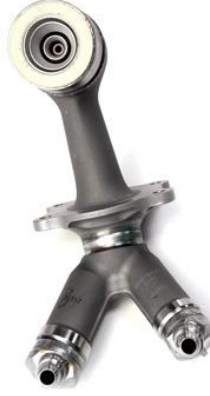
Şekil 1.79 : LEAP motoru yakıt nozulu
