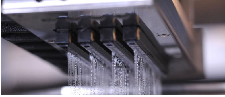
Şekil 1.88 : Binder jetting sistemi baskı başlığı
