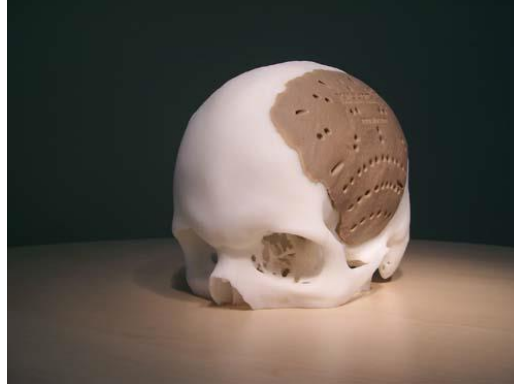
Şekil 1.104 : OXPEKK ile üretilmiş kafatası implantı
