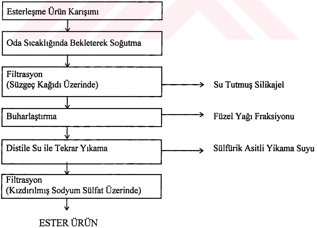
Şekil 3.23. Esterleşme ürün karışımına uygulanan rafinasyon işleminin şematik gösterimi.
